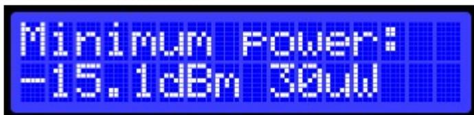
Le menu de "Minimum power" affiche la puissance minimale mesurée en dBm et Watt depuis que l'appareil a été mis sous tension ou les valeurs statistiques ont été réinitialisées.
