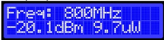
La première ligne indique la fréquence sélectionnée, l'atténuation et l'erreur de mesure.
