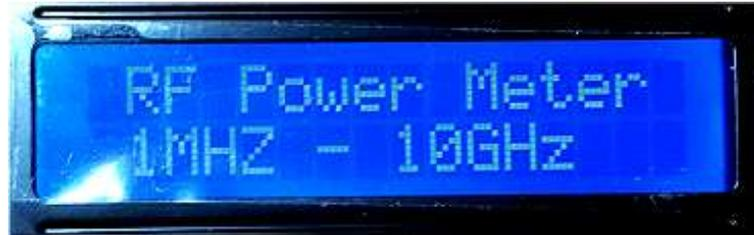
Le wattmètre peut mesurer la puissance des fréquences entre 1MHz et 10GHz avec 0.1dB de résolution et une précision de 0.1dBm. La fréquence à mesurer peut être réglée par incréments de 10 MHz et l'atténuation peut être réglée par incréments de 0.1 dB.
