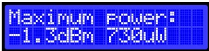
Le menu de "Maximum power" affiche la puissance maximale mesurée en dBm et Watt depuis que l'appareil a été mis sous tension ou les valeurs statistiques ont été réinitialisées.
