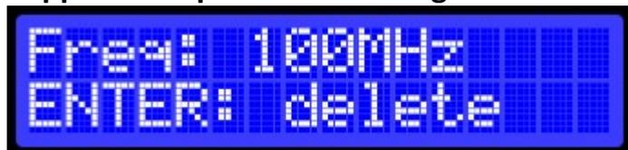
Affiche une fréquence pour laquelle un point de calibration a déjà été ajouté. Ce point d'étalonnage peut être supprimé en appuyant sur le bouton « Enter ». Le wattmètre reviendra aux données d'étalonnage par défaut.
