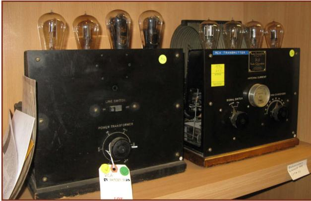
**RCA ET-3619 Transmitter & ET-3620 Rectifier**
