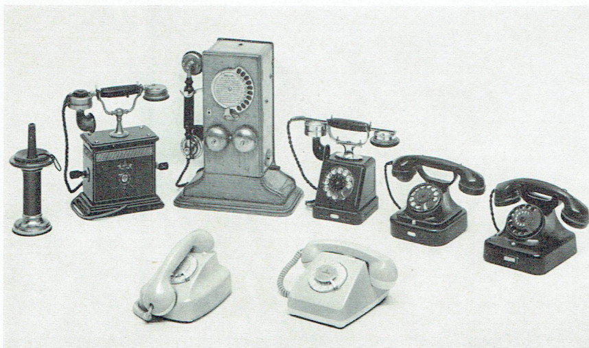
Fig. 5 L'alignement historique des postes téléphoniques mobiles révèle le bouleversement du sens esthétique jusqu'à nos jours. Il démontre de même pertinemment que la forme des appareils dépend des matériaux disponibles et de leurs facultés d'usinage. Les progrès réalisés dans ce domaine orientent toujours le constructeur vers des solutions plus économiques et plus fonctionnelles s'adaptant à l'évolution industrielle et culturelle
