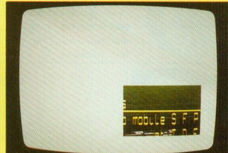
Fig. 16 : Effet «de diagonale» correspondant à l'apparition progressive d'un rectangle-image, de dimensions croissantes, se développant à partir du coin inférieur droit de l'écran-graphique.
