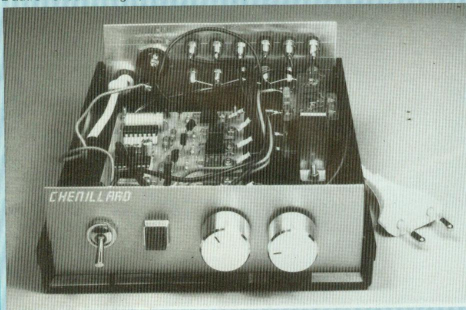
**Fig. 1a :** L'originalité de ce chenillard réside dans les réglages de la vitesse de défilement des spots ainsi que dans celui de leur intensité lumineuse.
