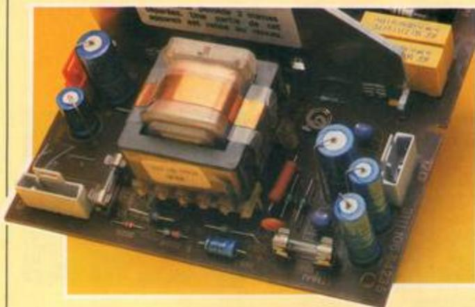
démarrage lent. L'information de courant maximal est prélevée dans l'émetteur du transistor de commande BU 826, aux bornes de la résistance de  $0,12 \Omega$  et filtrée par un réseau RC,  $1 \text{ k}\Omega$  et  $180 \text{ pF}$ . Finalement, la tension de contre-réaction, nécessaire à l'asservissement de l'alimentation à découpage, est prélevée sur un enroulement auxiliaire, la tension obtenue est redressée, filtrée et translatée, avant d'être appliquée à la borne 3 du circuit intégré.
