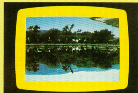
Image TV, accompagnée d'un bandeau de couleur jaune, obtenue à partir du module d'incrustation et de l'instruction : SCREEN 0,0,3,,1.
