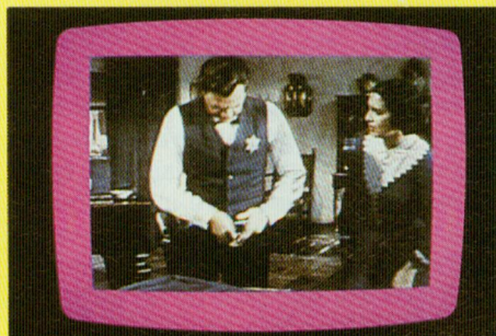
Transformation d'une image TV, avec bandeau de couleur violette, effectuée avec le module d'incrustation, à partir de l'instruction : SCREEN 0,0,5,,1.
