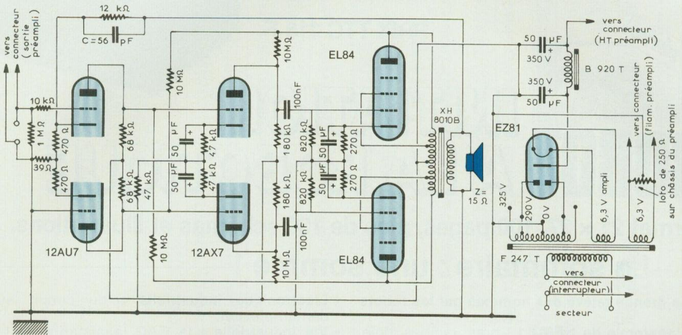
Schéma de l'amplificateur «Grand Amateur» Loyez - 12 watts.
