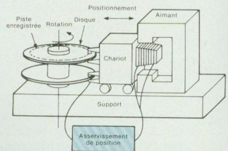
Fig. 5 : Schéma simplifié d'une unité de disques durs.
