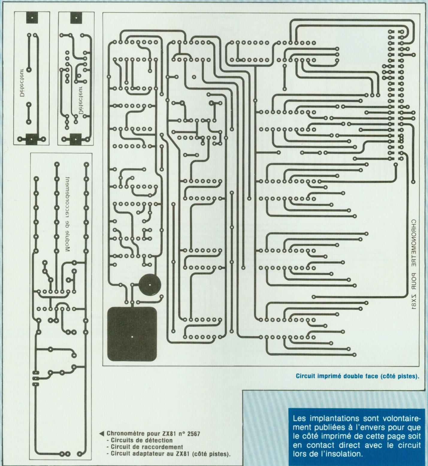
Circuit imprimé double face (côté pistes).
