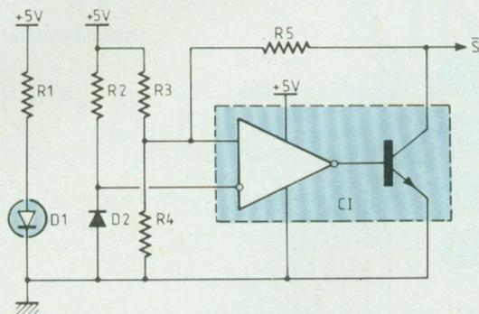
Entrée pour interrupteur à contact tenu ou pour départ avec rupture de conducteur (module de raccordement).
