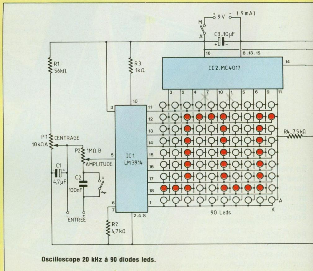
Oscilloscope 20 kHz à 90 diodes leds.
