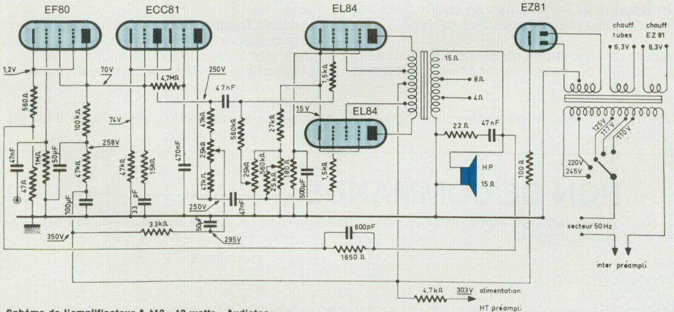
Schéma de l'amplificateur A 412 - 12 watts - Audiotec.
