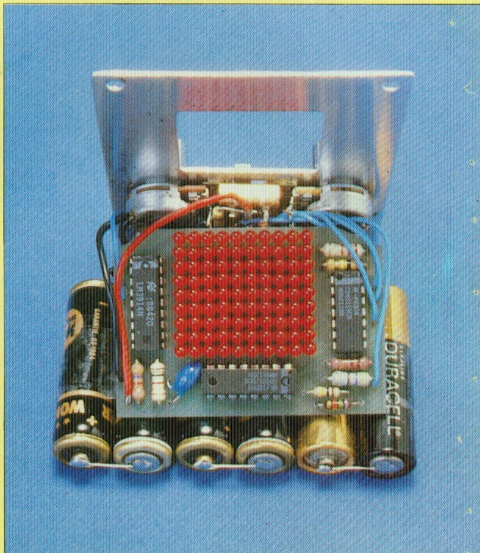
différences dans la tension de basculement de certains 4011, ce qui peut agir sur la synchro, et comme il n'y a pas de support il est préférable, dans la mesure du possible, de vérifier ceux-ci avant le montage.
