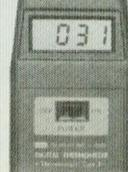
Rapide et précis (0,5%) ce thermomètre numérique permet de mesurer des températures de -50 °C à 750 °C. Une sonde NICAL est utilisée comme capteur.
