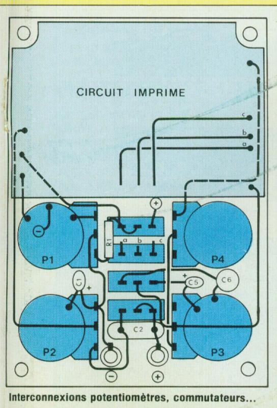
place et fixés par un point de colle néoprène, puis on fixera les potentiomètres et les deux fiches d'entrée. On pourra alors mettre le circuit imprimé en place et faire le câblage en s'inspirant du dessin ; les points de masse seront soudés directement sur les boîtiers des potentiomètres.
