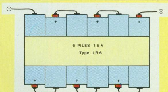
Alimentation de l'oscilloscope par 6 piles de 1,5 V montées en série.
