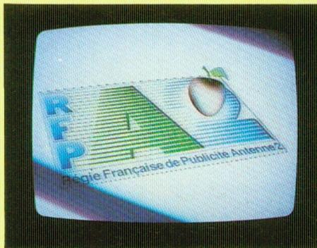
Fig. 2A : Obturateur focal, à déplacement horizontal, réglé au 1/60<sup>e</sup> s. On distingue deux barres obliques.
