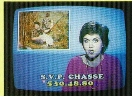
Fig. 3B : Obturateur focal, à déplacement vertical, réglé au 1/30<sup>e</sup> s. Le rectangle, légèrement foncé, est localisé dans la moitié inférieure de la photographie.
