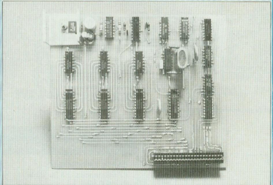
Carte principale du chronomètre qui se connecte à l'arrière du micro-ordinateur Sinclair ZX81 au moyen d'un connecteur 2 x 23 contacts.
