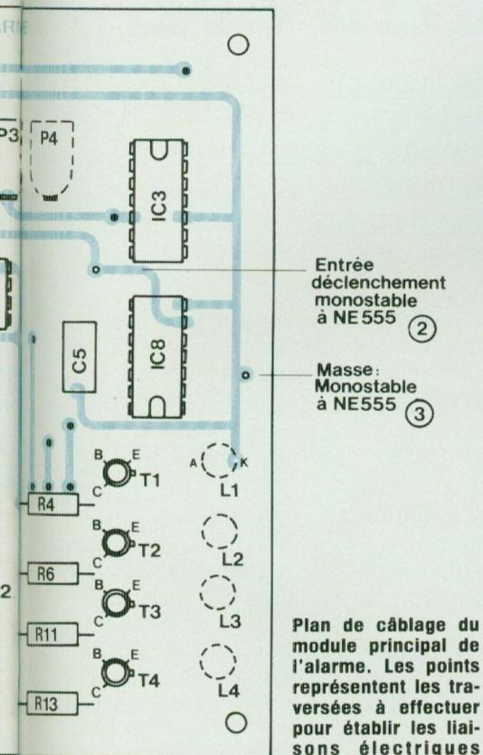
Plan de câblage du module principal de l'alarme. Les points représentés les traversées à effectuer pour établir les liaisons électriques entre les pistes situées sur les deux faces du circuit imprimé.
