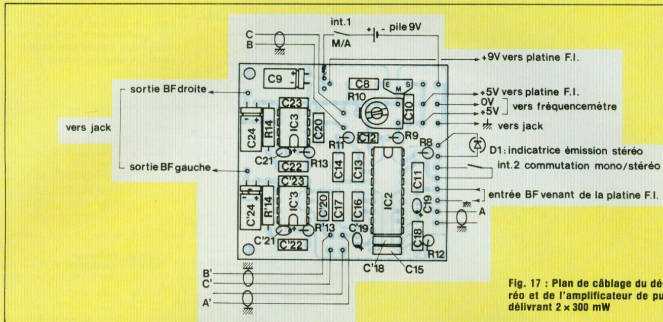
Fig. 17 : Plan de câblage du décodeur stéréo et de l'amplificateur de puissance BF délivrant 2 x 300 mW
