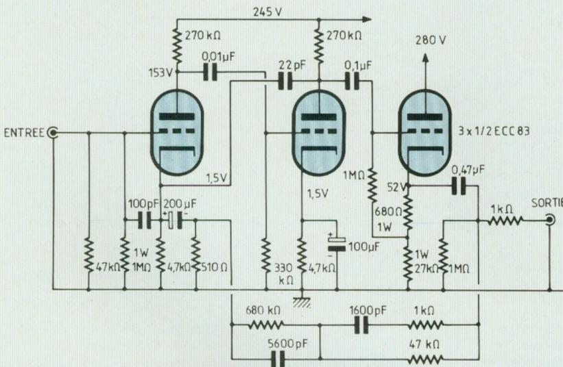
**Circuit du préamplificateur Marantz (partie RIAA). Le circuit de contre-réaction est de type cathode-cathode. La sortie est de type cathodyne. Longtemps, ce circuit resta une «référence» en matière de haute fidélité.**
