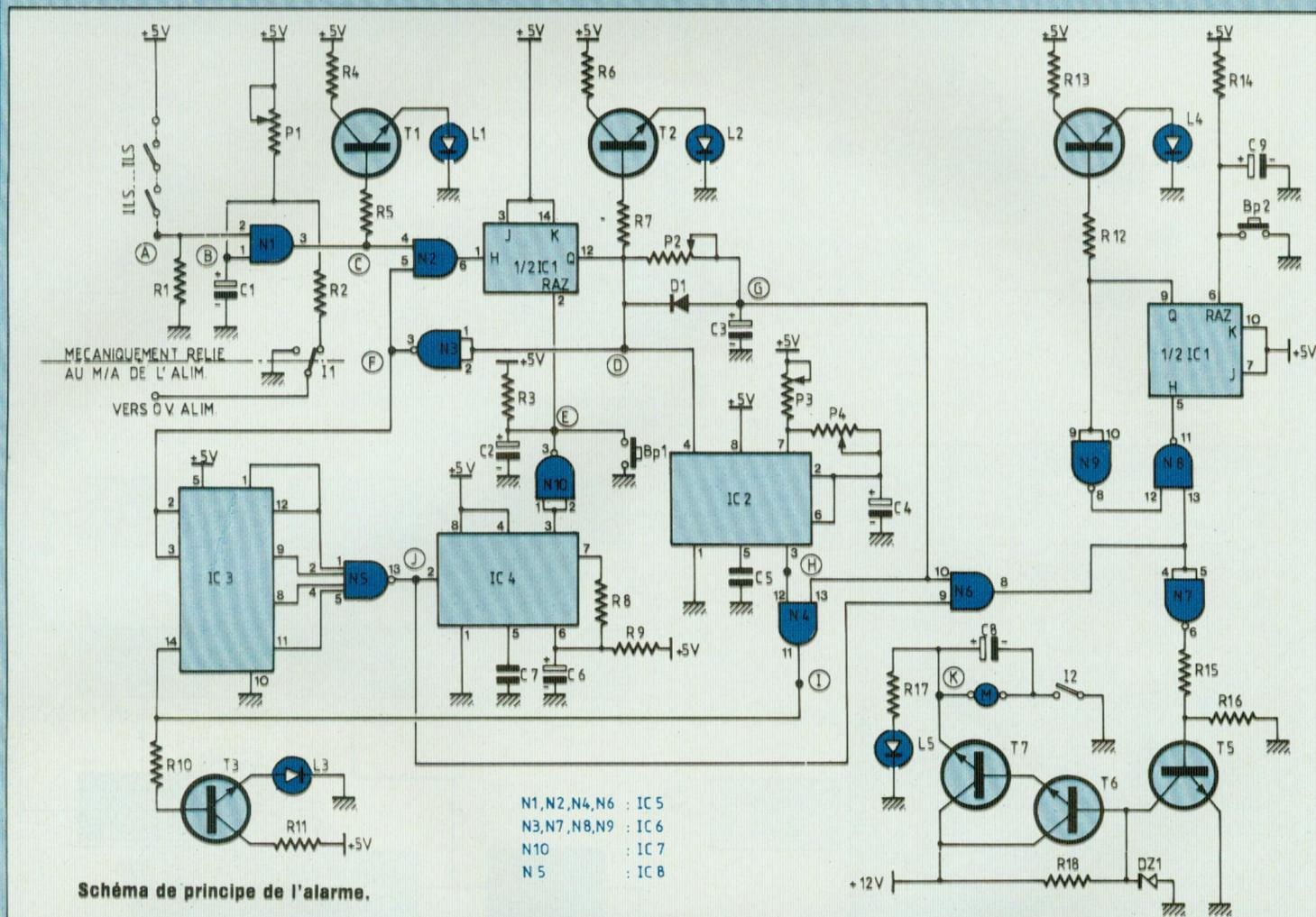
Mais pendant la période de comptage, la sortie de N5 est à l'état «1». Ce qui permet, si N6 comme N4 sont validés que le transistor T3 soit bloqué, il en ressort que le montage Darlington composé de T5 et T6 est saturé; la led s'allume, la sirène fonctionne.
