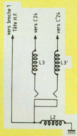
Si on se sert du fil du casque comme antenne, il faut alors placer les selfs L2, L3 et L3' pour éviter un court-circuit avec la masse et les sorties BF de l'amplificateur.
