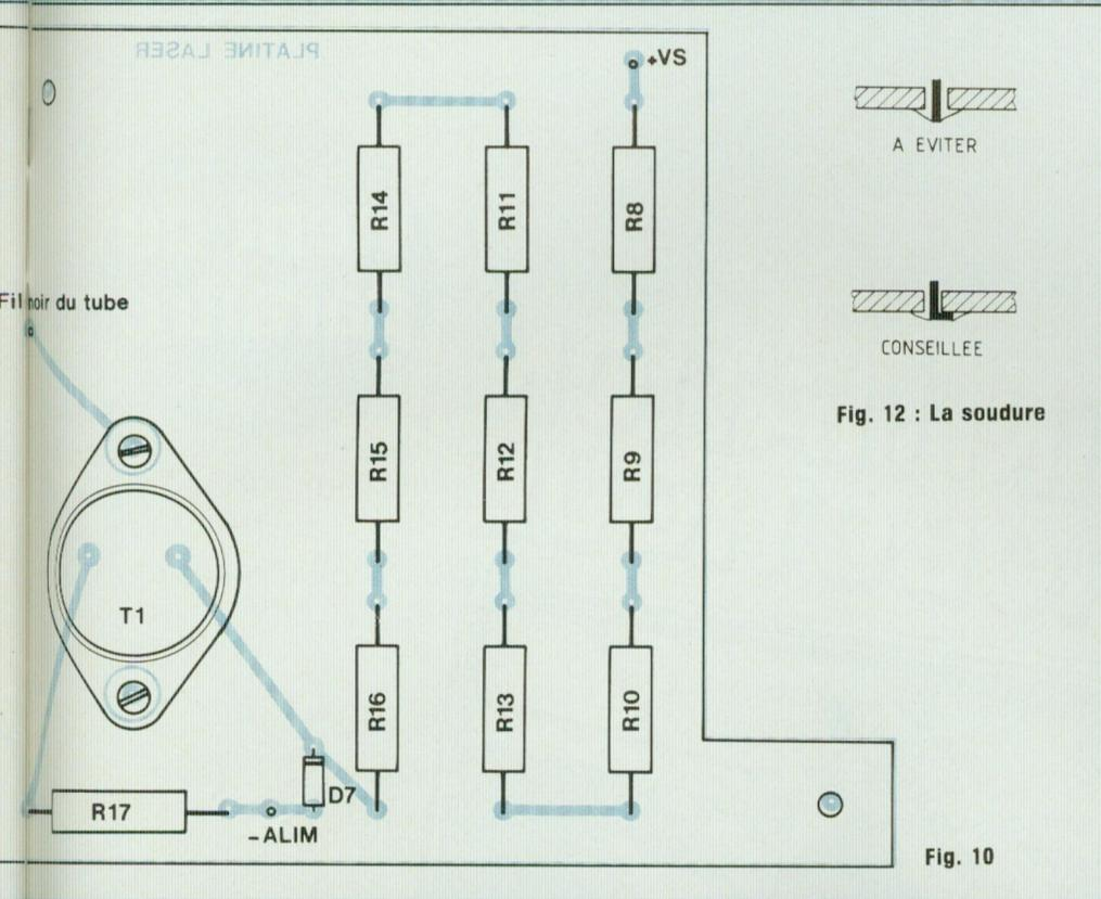
Fig. 12 : La soudure
