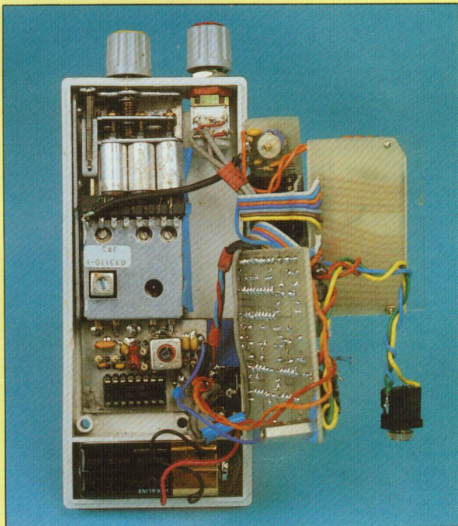
La réalisation de ce baladeur FM est, comme nous le montrent ces deux photographies, des plus compactes. Il n'y a pas de place de perdue dans le boîtier strapu 6002. La tête HF est d'excellente qualité. Ses 5 cosses de raccordement se soudent directement au circuit imprimé de la platine F.I. (circuit double face avec plan de masse).
