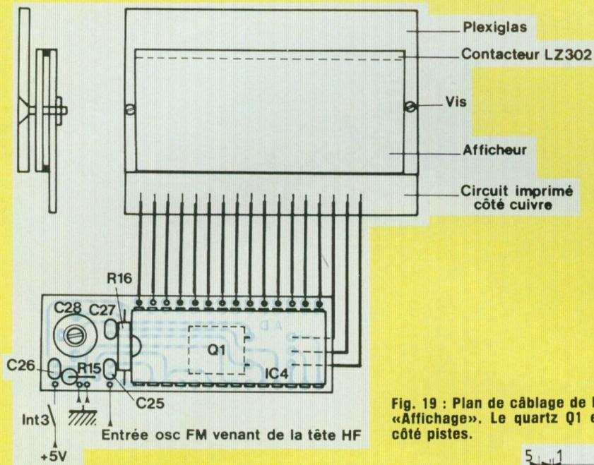
Fig. 19 : Plan de câblage de la section «Affichage». Le quartz Q1 est soudé côté pistes.
