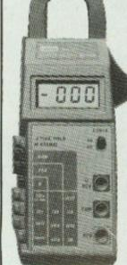
Il est évident que peu de techniciens ont besoin de mesurer des courants de 400 A. Cet appareil a une vocation industrielle et sa conception mécanique est faite en conséquence.
