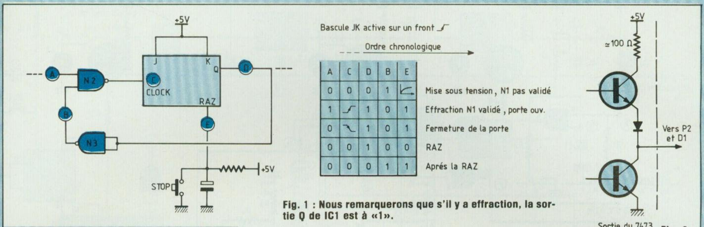
Fig. 1 : Nous remarquerons que s'il y a effraction, la sortie Q de IC1 est à «1».
