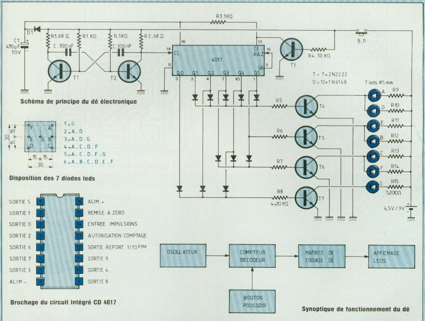
en prenant R en kΩ et C en μF, on obtient F en kHz.
