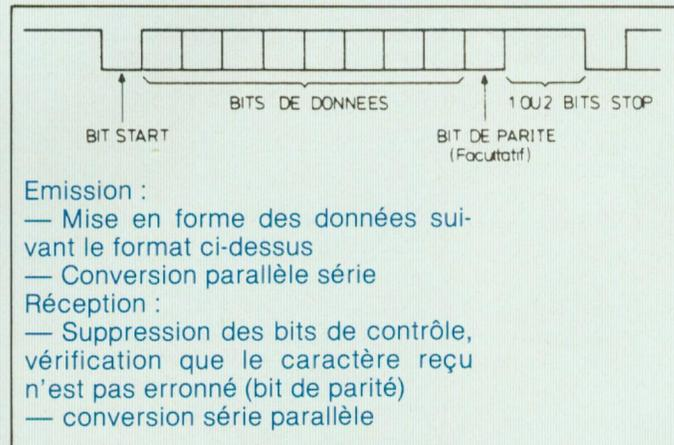
◀ Fig. 4 : Fonction d'un U.A.R.T. (Universal Asynchronous Receiver Transmitter). Led n° 9
