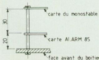
Fixation des modules contre la face avant du boîtier.
