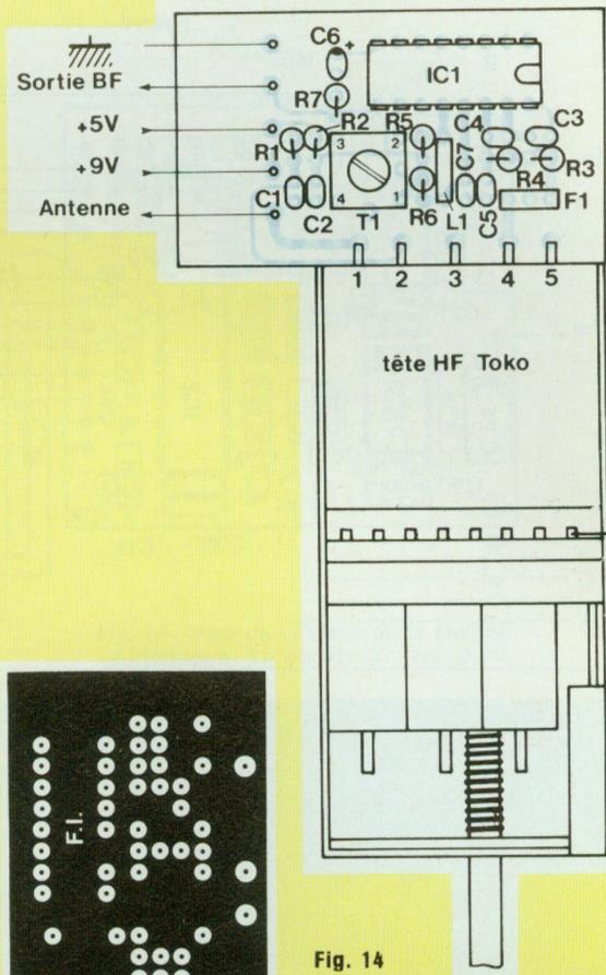
Plan de câblage de la platine F.I. Les éléments reliés à la masse sont soudés côté composants (au plan de masse).
