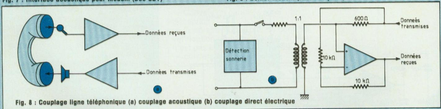
Fig. 8 : Couplage ligne téléphonique (a) couplage acoustique (b) couplage direct électrique
