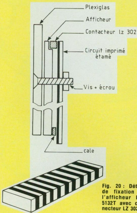
Fig. 20 : Détails de fixation de l'afficheur FAN 5132T avec connecteur LZ 302
