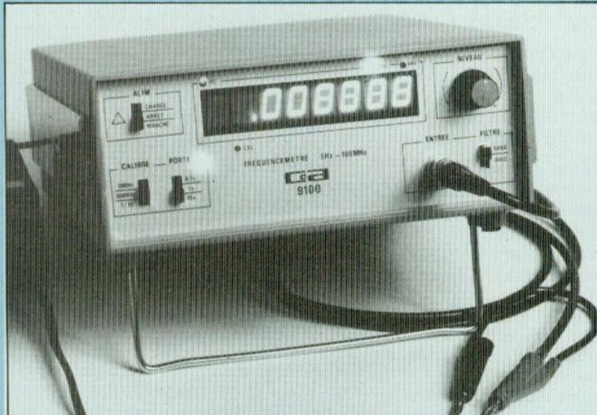
CDA commercialise ce nouveau produit permettant d'effectuer des mesures de fréquence allant de 5 Hz à 100 MHz sélectables en 2 gammes : 5 Hz-10 MHz, 10 MHz-100 MHz.
