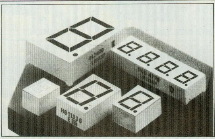
Fig. 9 : Différents exemples d'afficheurs 7 segments. ▶
