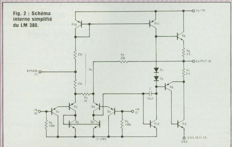
Fig. 2 : Schéma interne simplifié du LM 380.
