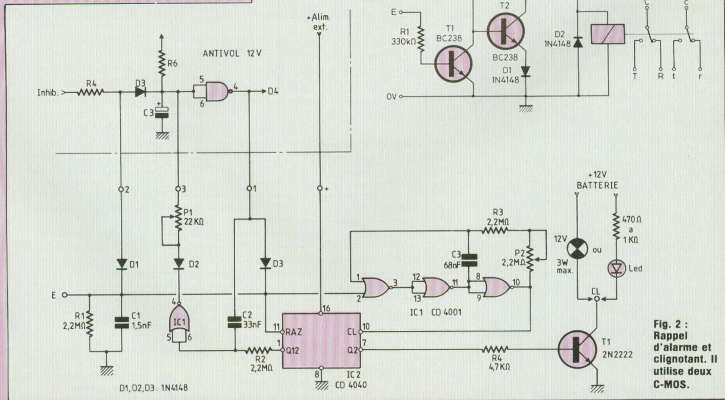
**Fig. 2 : Rappel d'alarme et clignotant. Il utilise deux C-MOS.**
