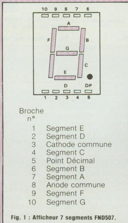
Fig. 1 : Afficheur 7 segments FND507.
