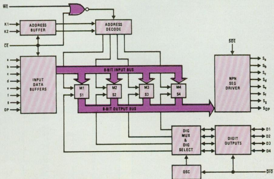
Fig. 6 : Schéma interne du MM 74C911.
