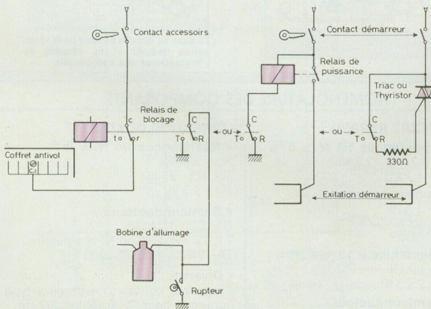
Fig. 7 : Branchements divers du relais de blocage.
