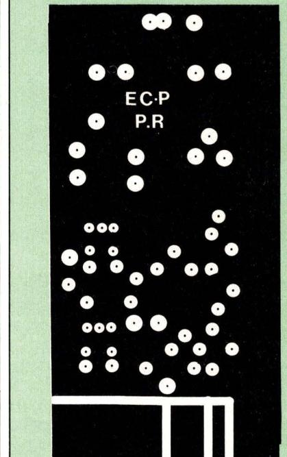
Il est fait appel à un circuit double face pour la tête haute fréquence. La partie supérieure fait office de plan de masse.
