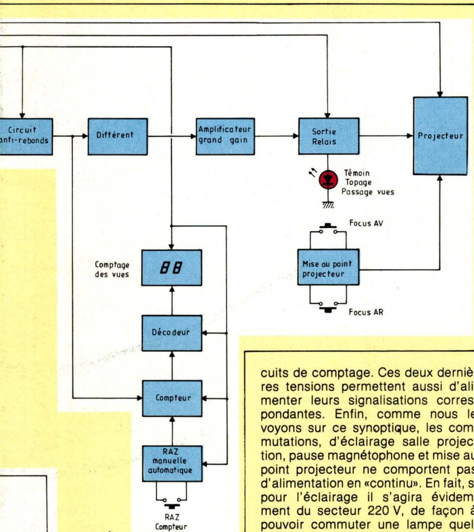
△ Fig. 2 : Schéma synoptique complet du central, toutes les parties techniques s'y trouvent ainsi que les différentes commutations, réglages et signalisations.
