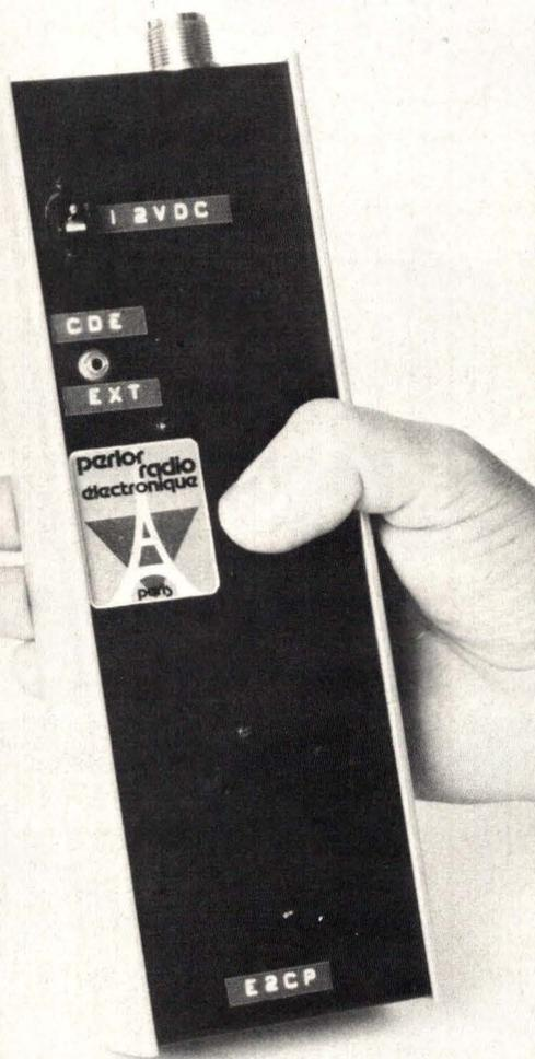
Dans le numéro 13 de Led nous avons décrit un émetteur et un récepteur destinés à la transmission d'ordres (réf. de l'ensemble : ECM et R1CD). Rappelons que cet ensemble permet de commander la fermeture d'un relais à distance par action sur un bouton poussoir. La liaison s'effectue par ondes radio codées. Elle se caractérise par une très grande sécurité de fonctionnement puisqu'en aucun cas le récepteur ne peut réagir à un autre émetteur. Aucun déclenchement parasite n'est possible.
