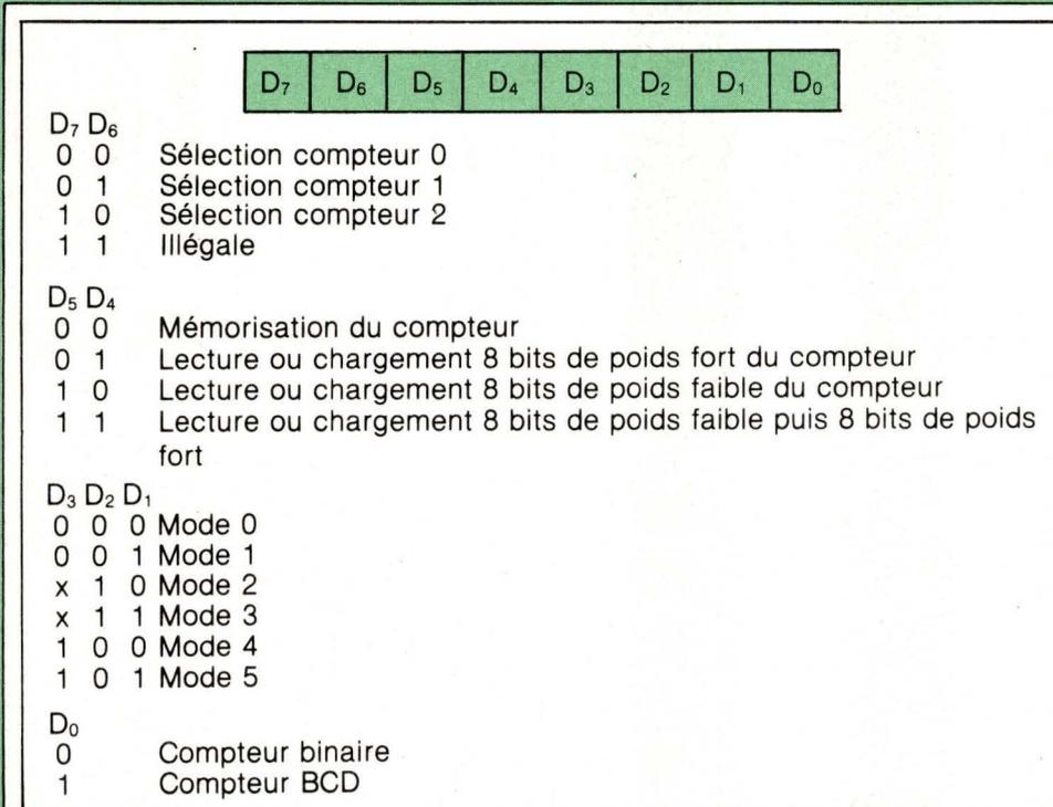
Fig. 3 : Signification des différents bits du registre de contrôle.
