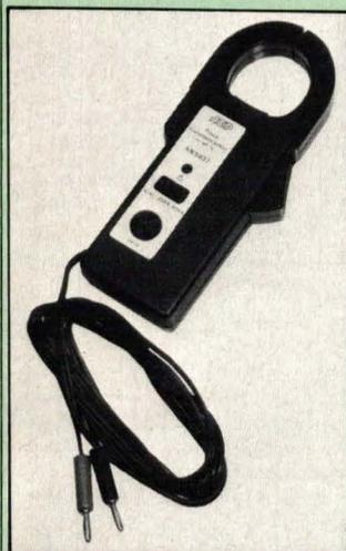
Pour compléter sa gamme de multimètres numériques, la division « Mesures » de l'A.O.I.P. présente une pince transformateur portable, type AN 5837, pour courants électriques continu, alternatif ou alternatif + composante continue.
