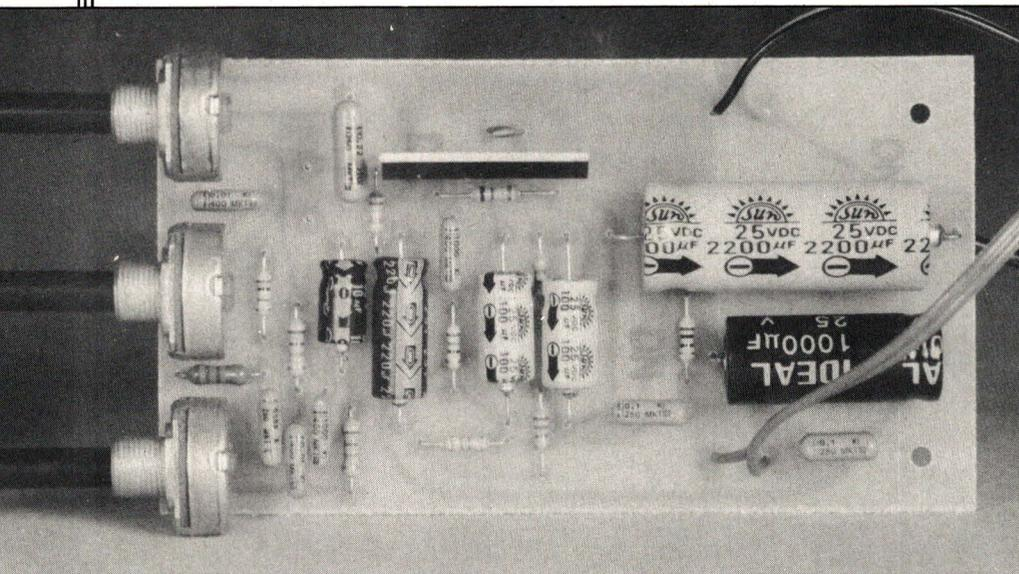
Nous vous proposons de réaliser ce petit amplificateur 5 W-4 ohms, de construction simple. Aucun réglage ni alimentation spéciale n'est nécessaire. Utilisable en appartement pour amplifier un lecteur de cassettes genre Walkman, en voiture comme amplificateur supplémentaire et pour bien d'autres usages suivant vos besoins.
