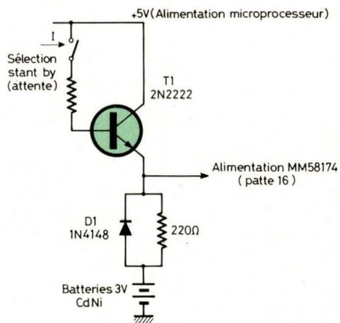
Fig. 14 : Alimentation du MM58174 sur batteries.
