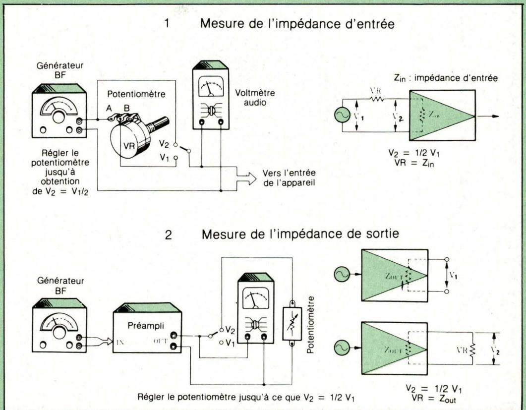
Fig. 1 : Mesure de l'impédance d'entrée et de sortie.
