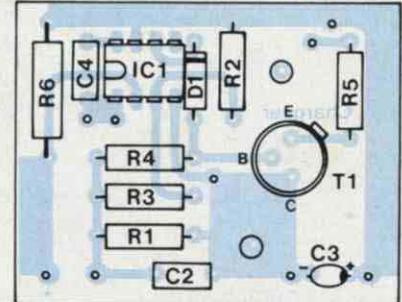
Fig. 5 : Attention à l'orientation de la diode D1.
