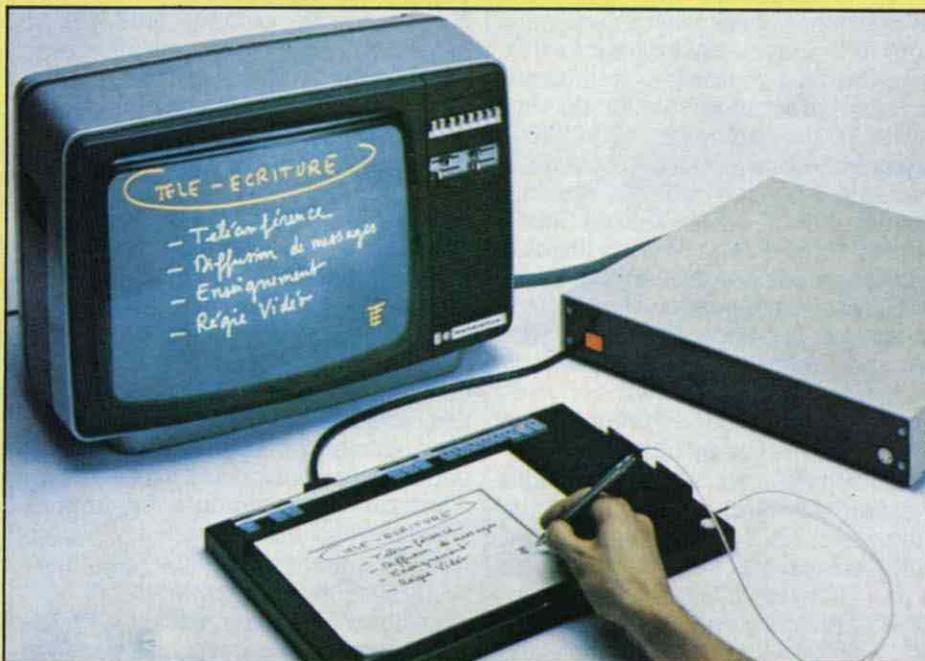
Dispositif de télé-écriture, proposé par les PTT. Il permet à des interlocuteurs reliés par le téléphone d'échanger simultanément des informations graphiques.
