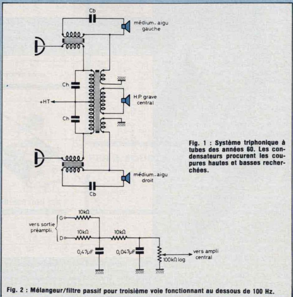
Fig. 1 : Système triphonique à tubes des années 60. Les condensateurs procurent les coupures hautes et basses recherchées.
