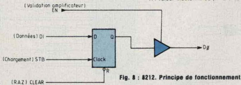
Fig. 8 : 8212. Principe de fonctionnement.
