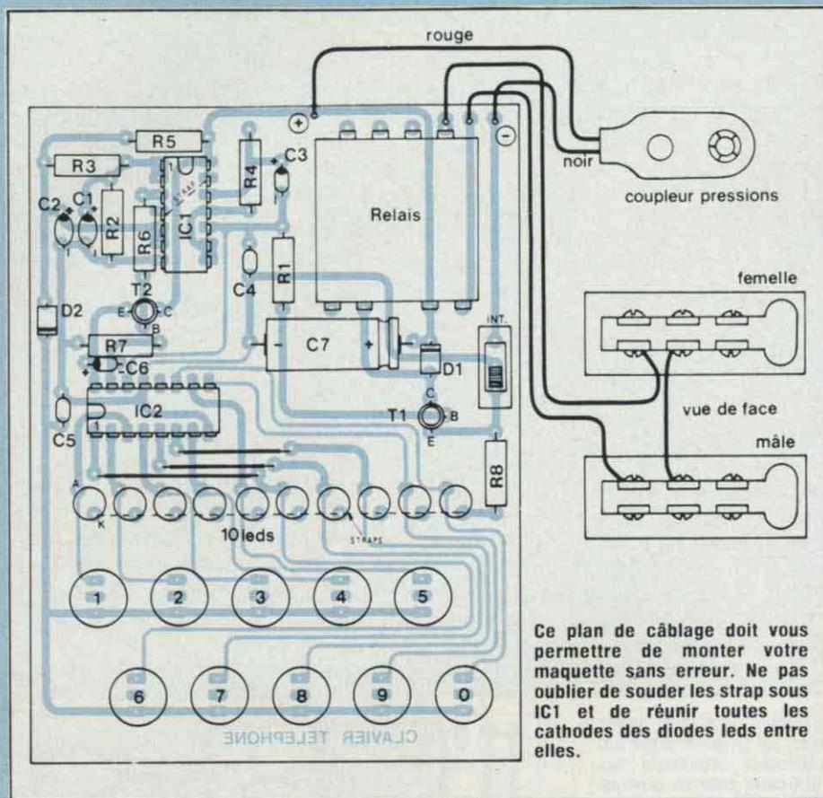
Ce plan de câblage doit vous permettre de monter votre maquette sans erreur. Ne pas oublier de souder les strap sous IC1 et de réunir toutes les cathodes des diodes leds entre elles.
