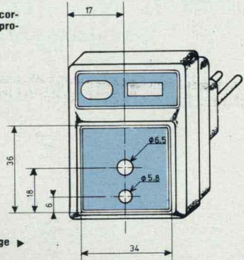
Fig. 12 : Usinage du boîtier.
