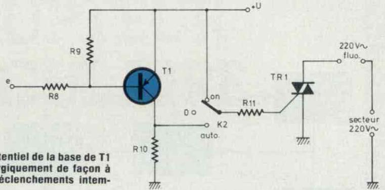
Fig. 4 : Le potentiel de la base de T1 est fixé énergiquement de façon à éviter des déclenchements intempestifs.
