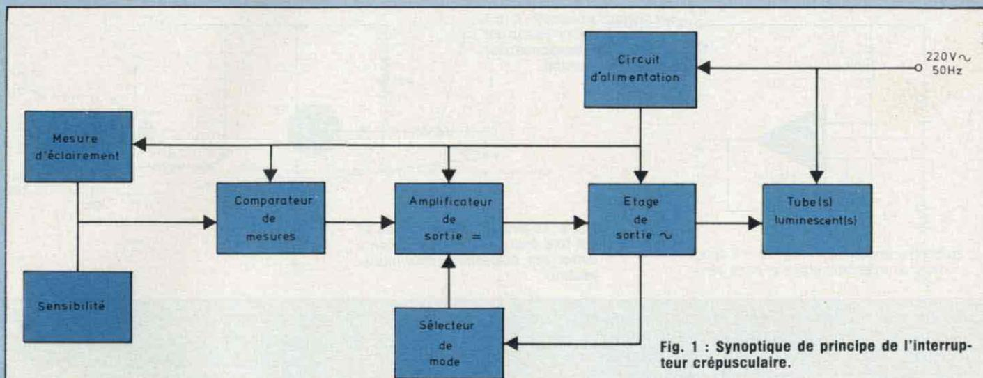
Fig. 1 : Synoptique de principe de l'interrupteur crépusculaire.
