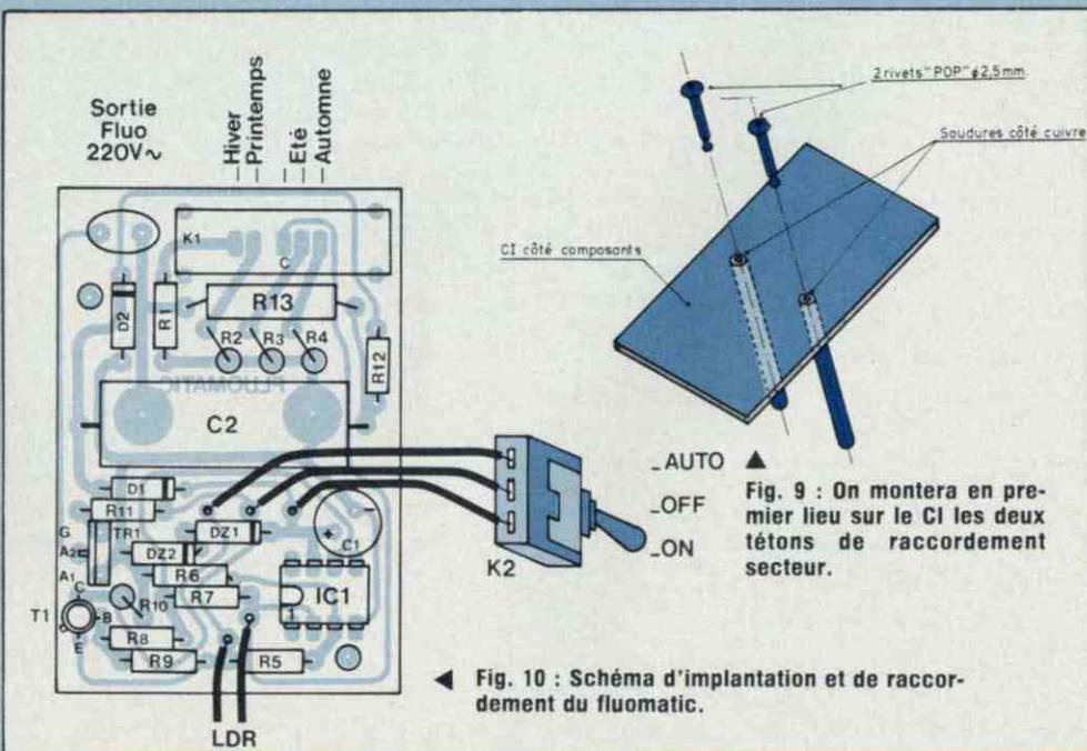
Fig. 9 : On montera en premier lieu sur le CI les deux tétons de raccordement secteur.
