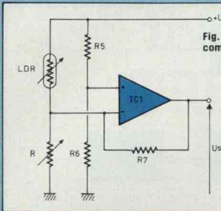
Fig. 3 : IC1 est monté en comparateur de tension.
