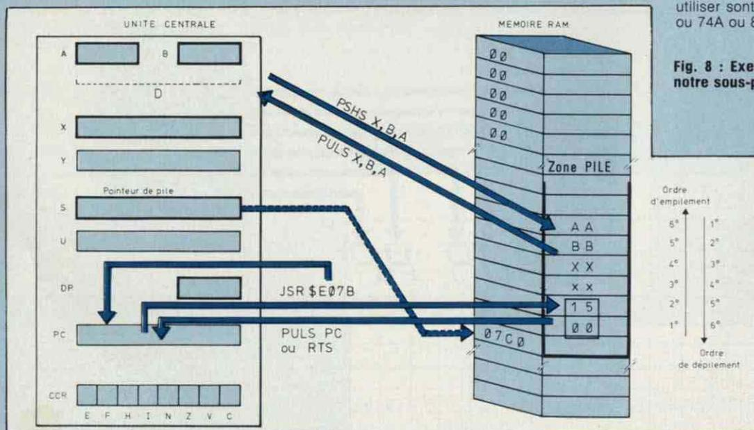
Fig. 8 : Exemple d'utilisation de la pile pour notre sous-programme d'affichage.
