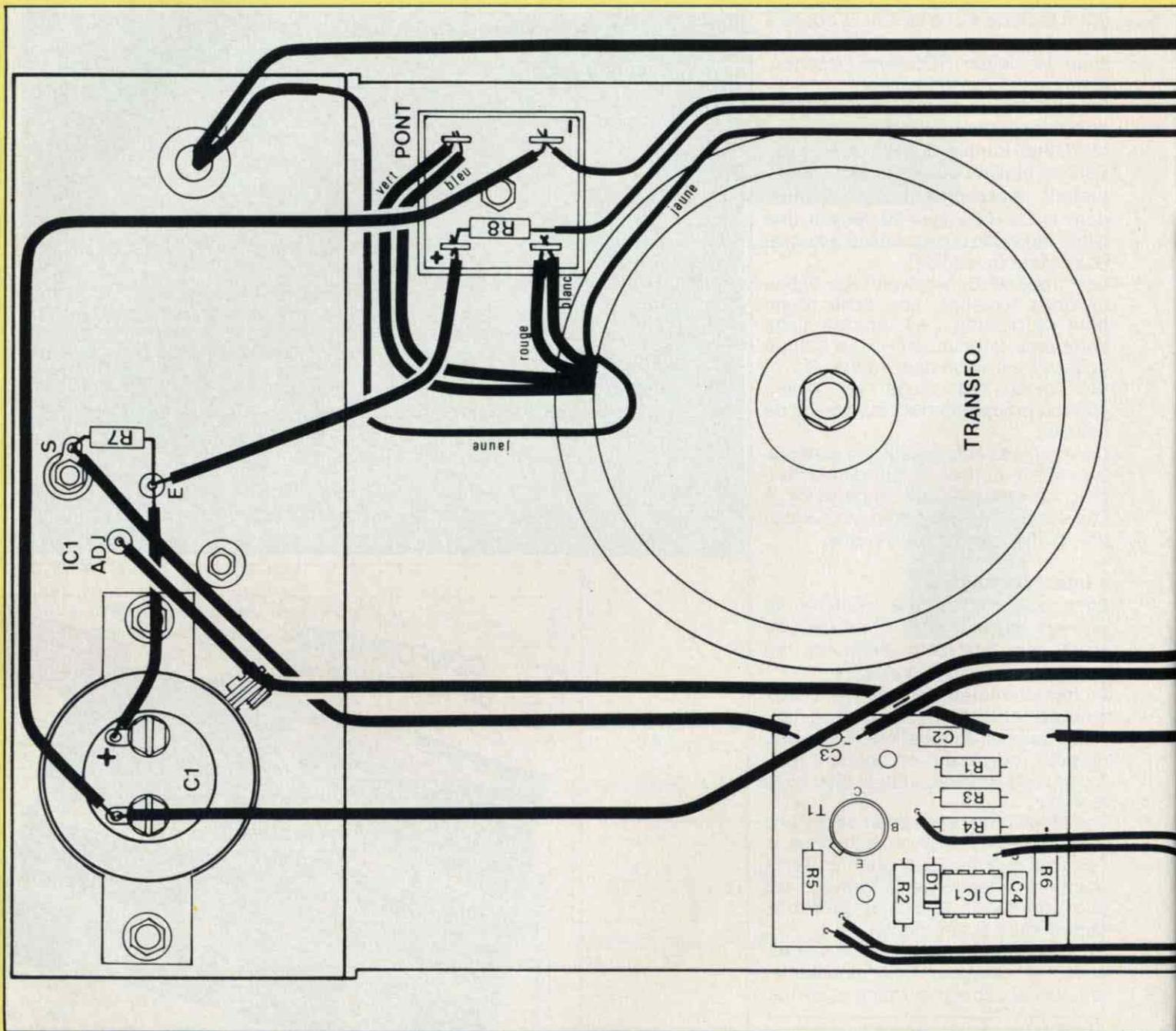
Plan de câblage détaillé du chargeur de batteries. Avant d'effectuer les interconnexions au LM 350, vérifier à l'ohm-mètre que son boîtier est bien isolé du châssis. Le fond du coffret en aluminium sert de dissipateur au pont redresseur. Aucun
