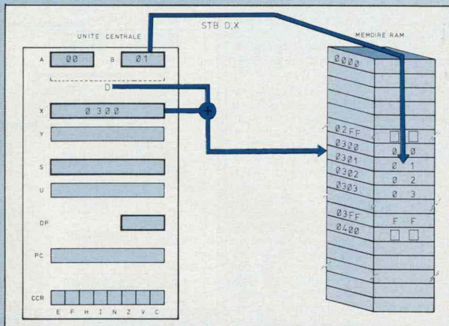
Fig. 2 : Adressage indexé à déplacement accumulateur.
