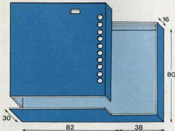
Coffret réalisé dans une feuille de plastique, pliée à chaud.
