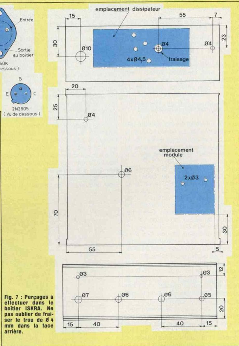
**Fig. 7 : Perçages à effectuer dans le boîtier ISKRA. Ne pas oublier de fraiser le trou de  $\varnothing 4$  mm dans la face arrière.**
