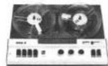
4 pistes. 2 vitesses (9,5 et 19 cm/s). Enregistrement MONO ou STEREO. Compteur 4 chiffres avec remise à 0. 2 Vu-mètres (1 canal graves, 1 canal aigus). Prise pour 2 micros. Prises Magnétophone, Radio Tuner.
