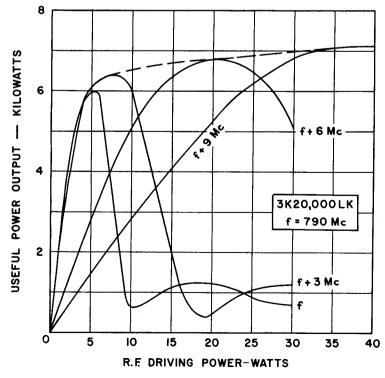
USEFUL POWER OUTPUT VS. R.F. DRIVING POWER (MIDDLE CAVITY DETUNED; INPUT & OUTPUT CAVITIES TUNED TO DRIVE FREQUENCY)
