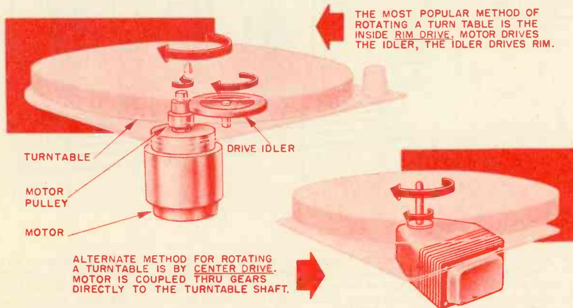
THE MOST POPULAR METHOD OF ROTATING A TURNTABLE IS THE INSIDE RIM DRIVE. MOTOR DRIVES THE IDLER, THE IDLER DRIVES RIM.
