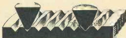
GOOD STYLUS PICKS UP HIGH FREQUENCIES; POOR ONE SKIPS THEM AND DAMAGES RECORD
