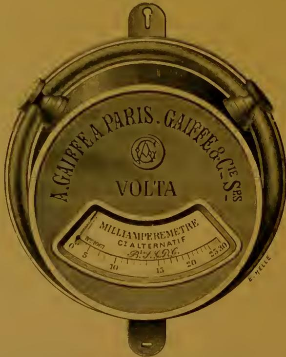
Fig. 18. — Milliampèremètre pour la haute fréquence.
