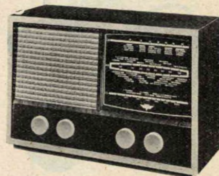
Un récepteur lui aussi typiquement anglais : le superhétérodyne 5 lampes, 3 gammes, de Kolster Brandes Ltd. Il est muni d'une antenne intérieure sur ferrite et d'un H.P. de 17 cm. L'ébénisterie est plaquée de noyer.
