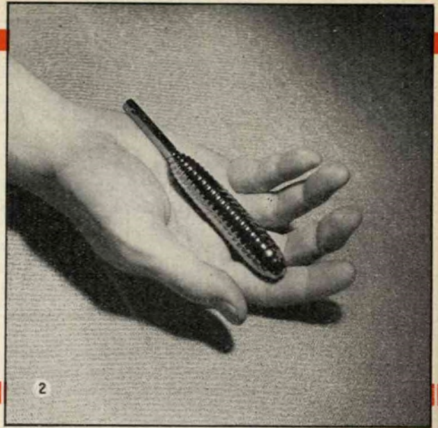
2. — Le mono-cristal, qui est né en deux heures d'un petit cristal-germe amené au contact du germanium liquide et soulevé lentement tout en tournant sur lui-même, pèse maintenant plus de 100 grammes. A l'intérieur, quelques centaines de jonctions n-p sont prêtes à fournir environ 2000 transistors.
