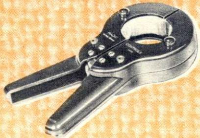
S'utilise avec tout Contrôleur Universel (Super-Polytest ou Multitest) pour la mesure des intensités alternatives de 10 à 1.000 Ampères. Contrôle facile phase par phase, sans démontage ni arrêt. Dimensions = 220 x 98 mm. Poids = 0 kg. 700
