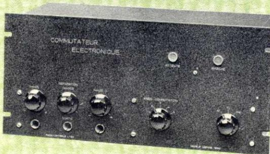
Complète l'oscilloscope pour l'observation simultanée de deux phénomènes.
