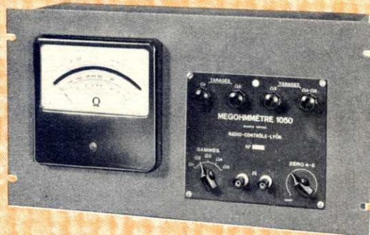
Permet la mesure de tous les isolements et résistances Radio du dixième d'ohm à 50.000 mégohms.
