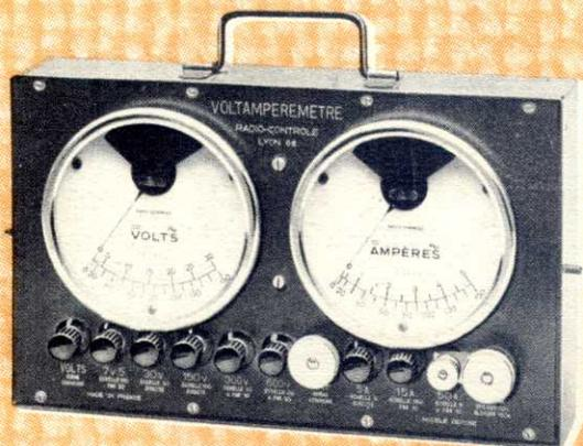
Instrument de mesure indispensable à l'Electricien. Portable, pratique, précis et robuste. Coffret métallique incassable. Voltmètre électromagnétique diam. 125 mm. à 5 sensibilités. 7,5 - 30 - 150 - 300 et 600 volts alternatif et continu. Ampèremètre électromagnétique diam. 125 mm. à 4 sensibilités. 5 - 15 - 50 et 150 Ampères alternatif et continu. Echelles multiples, lecture facile. Couvercle détachable. Dimensions = 340 x 210 x 100 mm. Net = 3 kgs Brut = 4 kgs
