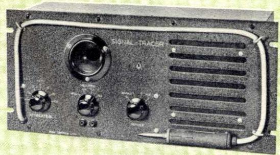
Le SIGNAL TRACER suit étage par étage le signal envoyé à l'entrée du récepteur pour un dépannage facile et rapide selon la méthode Américaine du SIGNAL TRACING.
