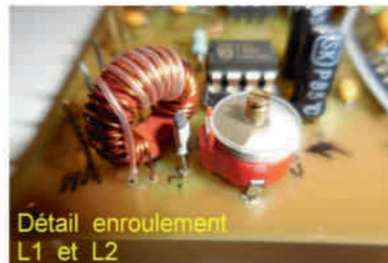
Détail enroulement L1 et L2
