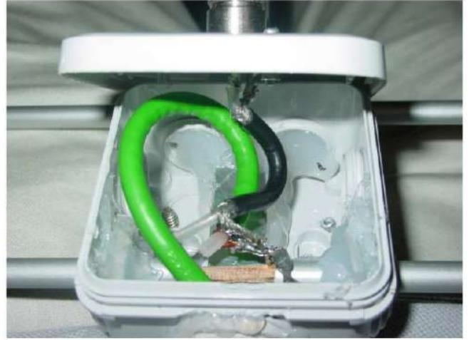
Photo du boîtier Plexo et stub d'adaptation
