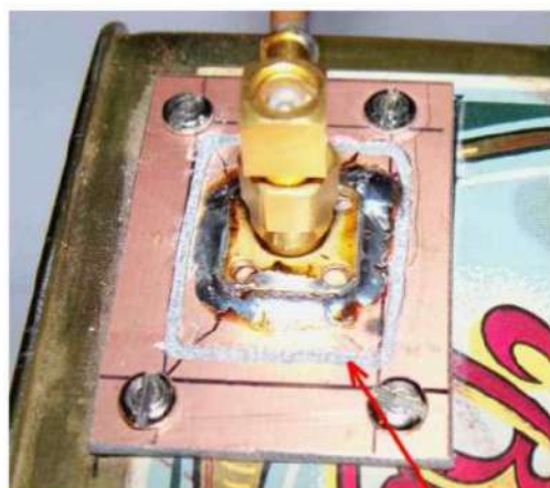
Détourage à la fraise pour isolation
