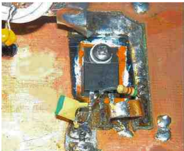
Le Mosfet est bien identifié comme étant un IRFZ14 et l'expérimentation sur le premier amplificateur STRONG-V1
