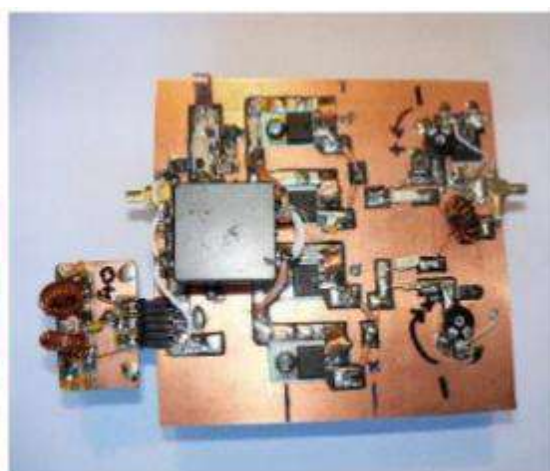
Détail de la disposition du filtre passe-bas enfichable en sortie du PA
