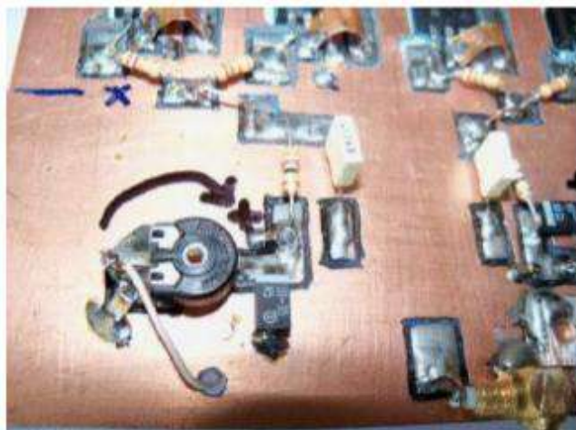
Résistance ajustable P1 et repérage du sens de rotation lors du réglage de la polarisation
