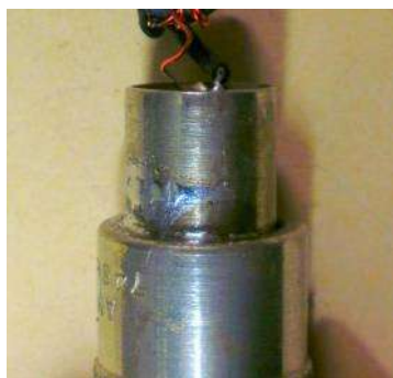
Détail de la soudure du manchon au corps de la SO239
