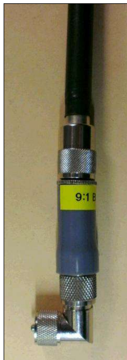
L'adaptateur terminé. L'antenne télescopique universelle a été mise en place et un coude a été vissé à sa base afin que l'antenne soit verticale.
