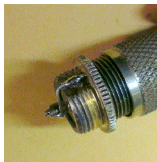
la soudure du petit fil nu de court-circuit âme-tresse de la SO239. Remarquez le type de prise employé.
