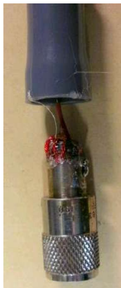
le balun est collé et il reste juste à enfoncer la PL dans le tube
