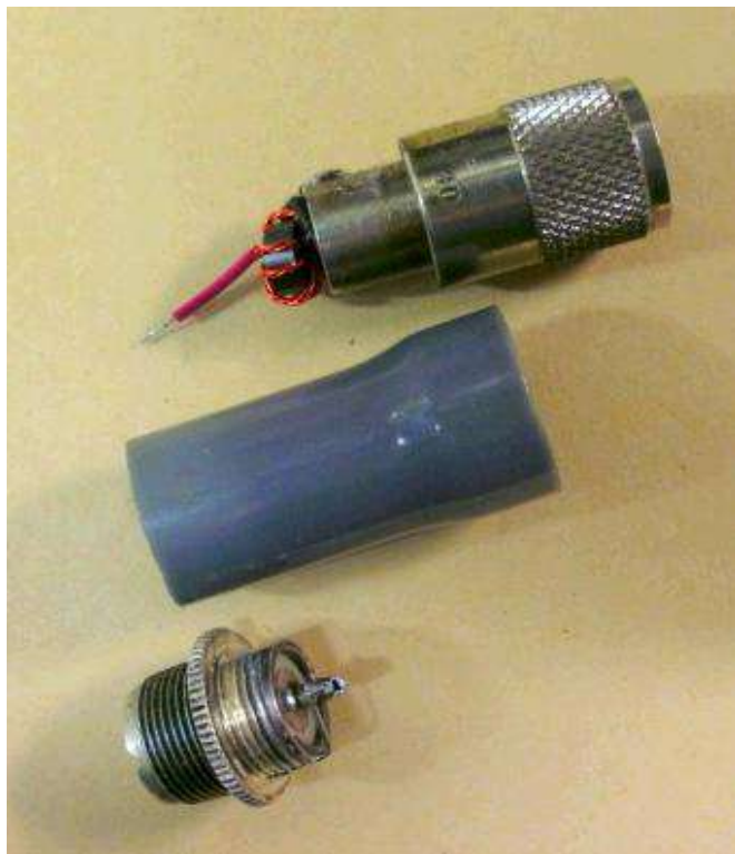
Les trois éléments. Le tube en PVC a déjà été formé à la chaleur.
