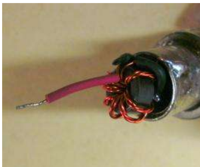
Le transfo est en place. Remarquez le fil rouge sortie "9:1"
