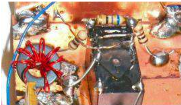
Atténuateur à résistance en \pi
