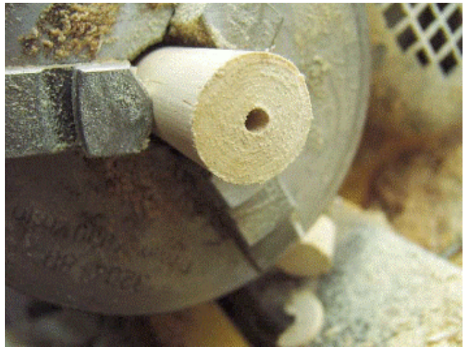
Un rondin de bois est découpé et percé au centre. Il reliera le fond du bobinage (ou il y a les fiches banane) au « chapeau » qui sert aussi de poignée.
