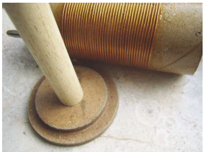
Le rondin de bois sera fixé au bouchon à l'aide d'une vis à bois adéquate.
