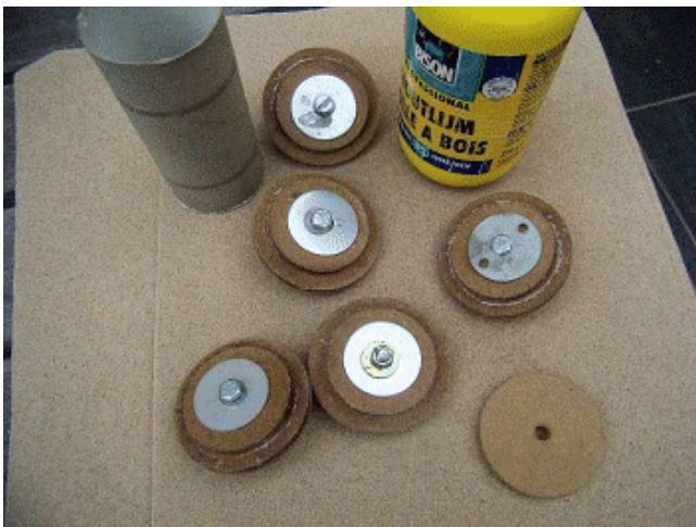
Les bouchons. Des disques de fibres devront encore être découpés à la scie-cloche. Une série correspondra au diamètre intérieur du tube de carton et l'autre série sera 15mm plus large afin de déborder et de pouvoir servir de poignée. Collez un petit disque à un grand disque avec de la colle à bois. Une vis de 6mm est enfilée sur une grosse rondelle de fer puis au travers de la plus petite rondelle puis de la grosse rondelle. Ajoutez encore une grosse rondelle puis l'écrou. Vous avez une presse sur mesure. Laissez sécher puis démontez le boulon et les rondelles. Votre bouchon est terminé.
