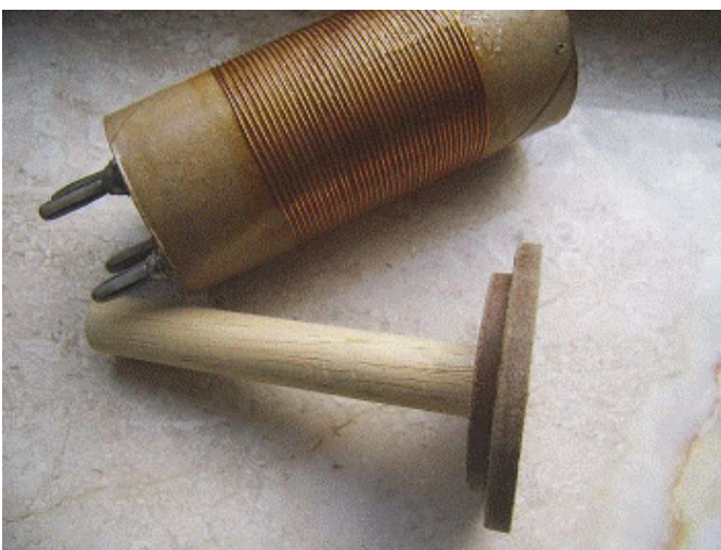
Le rondin de bois sera fixé au bouchon à l'aide d'une vis à bois adéquate.
