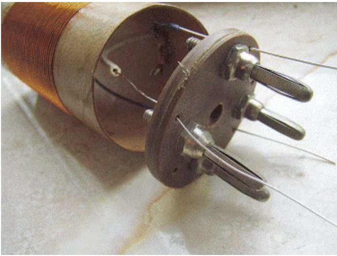
A g. : vue de l'autre côté du disque de fond. A dr., les fiches banane ont été récupérées sur des quartz ex-WWII US army modèle « FT171 » au rebut.
