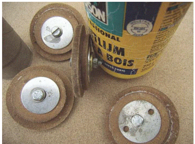
Les bouchons. Des disques de fibres devront encore être découpés à la scie-cloche. Une série correspondra au diamètre intérieur du tube de carton et l'autre série sera 15mm plus large afin de déborder et de pouvoir servir de poignée. Collez un petit disque à un grand disque avec de la colle à bois. Une vis de 6mm est enfilée sur une grosse rondelle de fer puis au travers de la plus petite rondelle puis de la grosse rondelle. Ajoutez encore une grosse rondelle puis l'écrou. Vous avez une presse sur mesure. Laissez sécher puis démontez le boulon et les rondelles. Votre bouchon est terminé.
