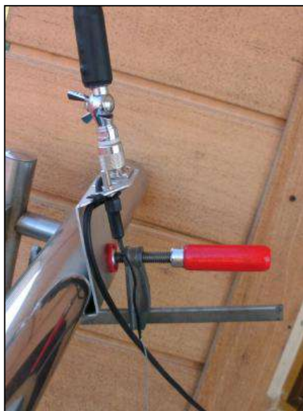
Vue du dessus. Le coaxial est fixé à demeure et fait une boucle avant d'être fixé par un collier "rilsan".
