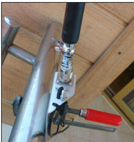
Vue du dessus. Le coaxial est fixé à demeure et fait une boucle avant d'être fixé par un collier "rilsan".
