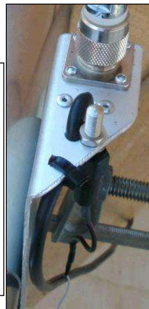
Vue du dessus. Le coaxial est fixé à demeure et fait une boucle avant d'être fixé par un collier "rilsan".
