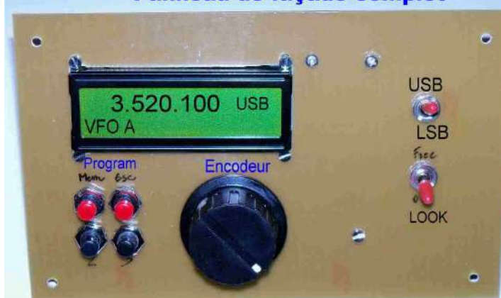
Photo 10 VFO Panneau de façade complet
