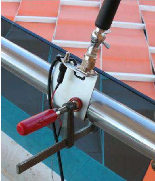
Le support d'antenne en place. Il est réalisé en tôle d'aluminium de 2mm. C'est un minimum. Description en fin d'article.
