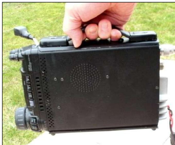
Coupez la partie femelle à bonne longueur et collez-la sous la tôle. Il sera utile de créer un creux vers l'extérieur de la tôle par martelage pour que la tête ne dépasse pas côté TX. La poignée pourra ainsi se visser proprement en place.
