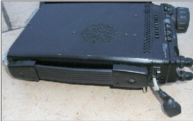
Diverses vues de la poignée. Tout en bas, l'aspect de l'ensemble vu du dessus : c'est propre, discret et très peu encombrant. De plus cela protège un peu les boutons et le câble micro
