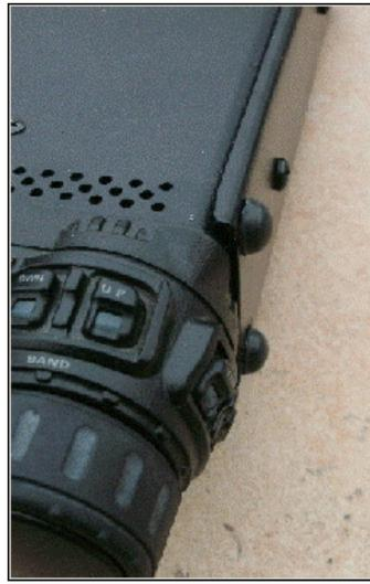
Vues des deux côtés permettant de voir le pliage des lames d'aluminium et la pose des pieds.
