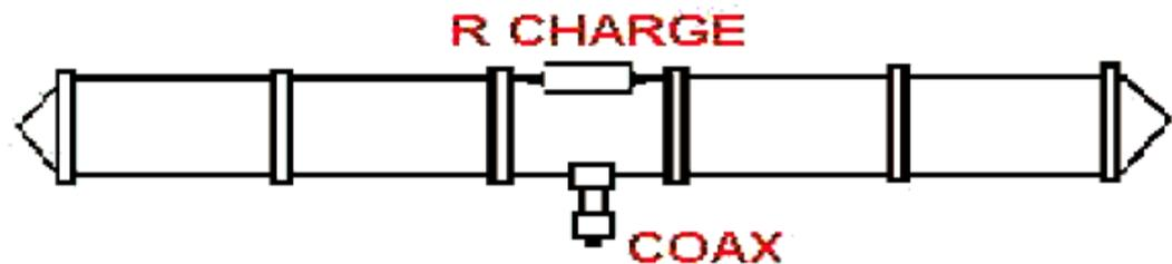
Cette antenne est fort séduisante car elle couvre toutes les gammes décadiques avec les caractéristiques suivantes (le balun est incorporé et un seul coaxial suffit):
