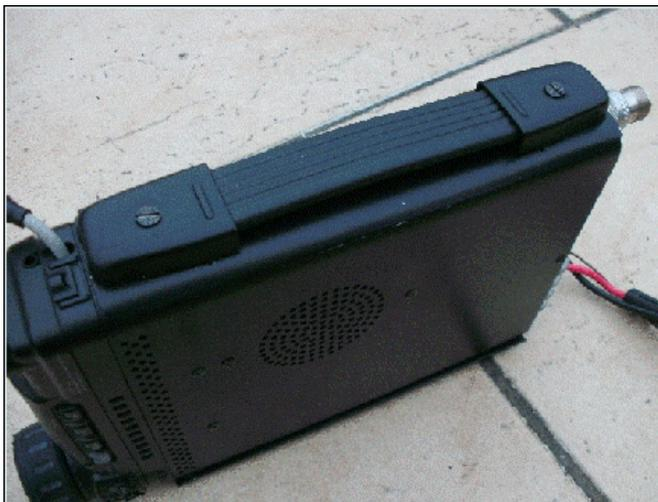
Le cordon gris est une extension du câble de micro destinée à « sortir » la fiche RJ45 afin de ne pas devoir démonter à chaque fois la face avant pour changer de micro.
