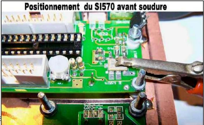
Positionnement du S1570 avant soudure
