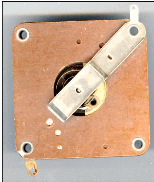
Il s'agissait d'un condensateur variable au mica. Ce sont des produits très bon marchés destinés à un large public. On les utilisait dans les postes à galène ou à réaction.
