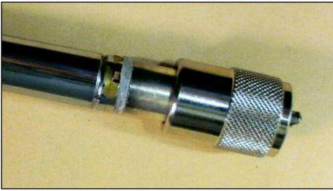
rigide et une PL de bonne qualité ; en laiton nickelé si possible car l'argenté va se ternir rapidement. Quand au zamac des accessoires CB, il est moins solide.
