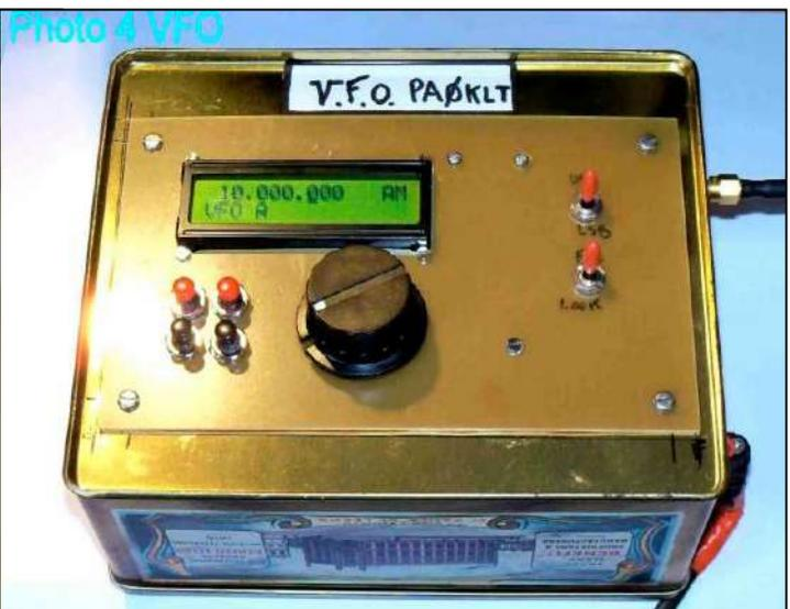
Ces 2 photos sont un exemple de montage du V.F.O. de PA0KLT qui a équipé le prototype du DEO 2 SSB lors des 1<sup>ers</sup> essais.
