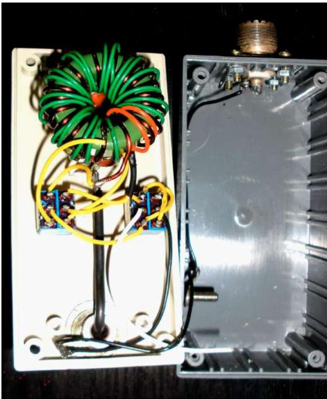
La spire supplémentaire de L1b : soudez les fils l'autre inverseur de S2 de façon à ce que ce soit le début du bobinage qui soit sélectionnée lorsque le levier est en HAUT.
