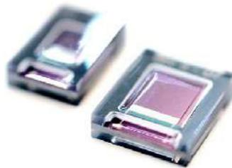
Le centre de recherche Imec à Louvain (Belgique) a conçu un récupérateur d'énergie intégré dans le pneu d'une voiture. À 70 km/h, il fournit une puissance de 42  $\mu$ W, suffisante pour alimenter un petit capteur sans fil. Un tel récupérateur d'énergie pourra être utilisé dans les pneus du futur, pour alimenter des capteurs qui collecteront et transmettront de l'information sur l'état du pneu, sa pression, l'état de la route et même le style de conduite du conducteur.
