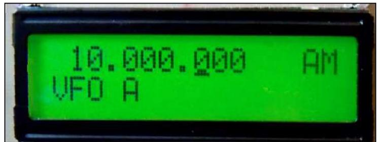
Connecter en volant un fil sur la sortie HF, comme indiqué sur la photo 13, allumer et écouter votre récepteur sur +/- 10 MHz en LSB ou USB. Vous allez entendre un fort sifflement. Déconnectez le fil de la sortie HF : le signal disparaît. Vous avez désormais la certitude du bon fonctionnement de votre construction. Vous pouvez poursuivre votre assemblage.
