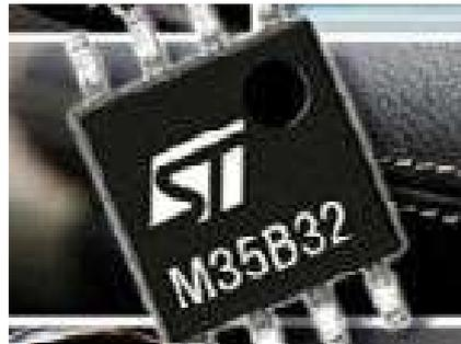
Elle s'alimente sous une tension unique de 2,5 à 5,5 V et offre en standard un bus de données sériel synchrone, sous la forme d'une interface SPI (Serial Peripheral Interface), désormais classique dans le monde des microcontrôleurs.
