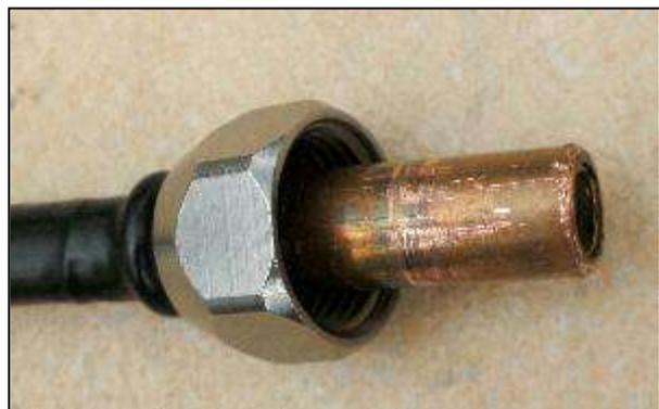
C'est un raccord schell nickelé (ils le sont tous, en principe. C'est à ça qu'on les reconnaît à première vue). Il sera prévu pour un tuyau de 10mm et sa base est un raccord mâle d'un diamètre de +/-19mm, à visser. Chauffez le tube comme décrit précédemment et vissez le raccord schell en force et à fond sur le tube en PVC. Fixez par une vis ISO de 3mm après avoir taraudé et en intercalant une cosse à souder. Si vous n'avez pas de taraud, mettez une petite vis parker (= "vis à tôle").
