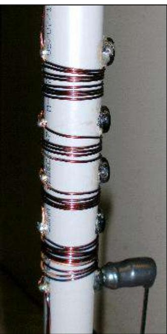
Décapez le fil là où il va passer dans l'encoche de la douille banane et soudez-le. Enfichez la banane du côté "articulation" de votre antenne télescopique ex-BCR dans la douille banane du bas et celle du haut dans la seconde à partir du haut.
