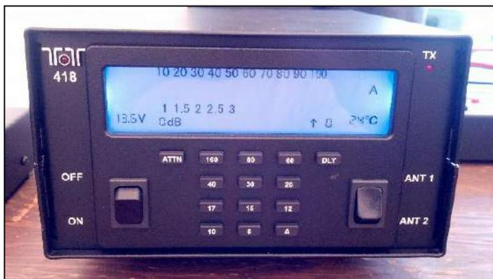
amplificateur de puissance modèle 418. Cet amplificateur peut aussi être utilisé avec n'importe quel autre appareil QRP aussi bien en station fixe que portable. Il n'est pas équipé d'un coupleur d'antenne intégré.
