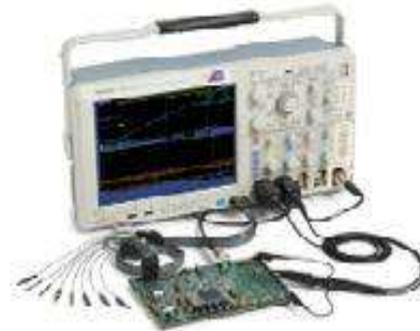
L'analyseur logique permet de décoder et afficher en même temps les signaux de quatre bus sériels ou parallèles.
