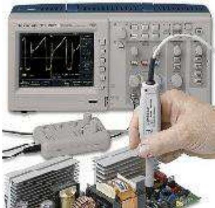
Aim-TTi innove avec une sonde de courant pour mesurer le courant dans les pistes d'une platine. La sonde de « courant positionnel » I-prober 520 utilise une technique brevetée pour mesurer le courant dans un conducteur sans que le courant passe à travers la sonde ou une résistance, comme avec les méthodes conventionnelles. Au lieu de ça, la sonde mesure le champ magnétique rapproché de la piste.
