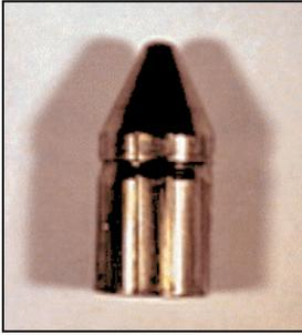
Le canon d'une arme présente inévitablement des microrayures qui sont créés lors de sa fabrication. Ces traces sont aléatoires et sont différentes d'une arme à l'autre, même si elles ont été rayées en série. Lorsqu'une balle est tirée, compte tenu de l'énorme pression interne due à la combustion de la poudre et aussi de la ductilité de l'enveloppe, ces rayures se retrouvent en négatif sur son enveloppe. L'identification de l'arme qui a été utilisée
