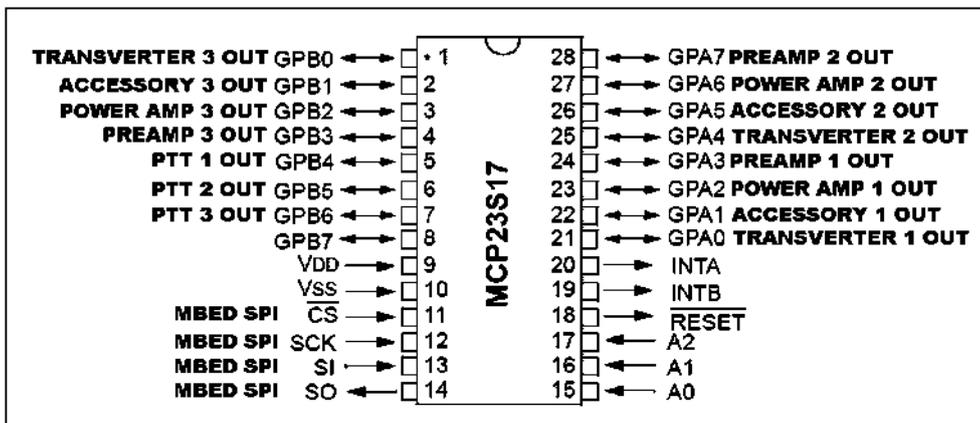
Configurable en 2 x 8 bits ou 16 bits, entrées et/ou sorties et lignes d'interruption. Au repos, l'IC ecole consomme... 1 uA.
