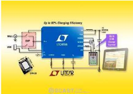
De très nombreux paramètres sont programmables tels que courant d'entrée, courant de charge, tension de la batterie en fin de charge, etc. Comme le nombre de broches du circuit intégré est insuffisant pour donner accès à toutes ces fonctions, c'est par un bus I2C que l'on passe pour les programmer.
