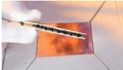
Dans un projet de recherche commun avec le constructeur automobile BMW, la récupération de chaleur des gaz d'échappement pour alimenter le système électronique d'un véhicule a déjà fait ses preuves. A terme, ce système pourrait remplacer le dynamo d'éclairage et ainsi réduire la consommation de carburant de 5%.
