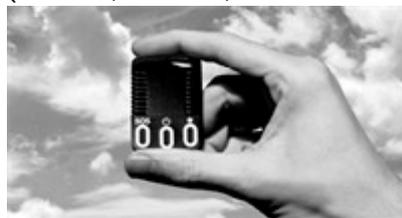
Le Beagle fonctionne comme un téléphone portable avec au choix un forfait ou une carte SIM prépayée. La communication se fait par SMS. Dans des endroits où il n'y a pas de réseau téléphonique, le dispositif peut mémoriser jusqu'à 6000 positions que l'utilisateur
