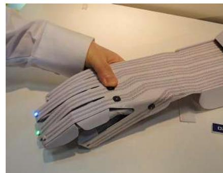
La société japonaise Nippon Mektron Ltd., fabricant des composants électroniques tels que des circuits imprimés flexibles (FPC) a présenté début juin un prototype d'un circuit imprimé élastique. Les circuits imprimés flexibles standards ne sont pas élastiques, car ils sont réalisés à partir de polyimide. Ce matériau est notamment connu pour sa thermostabilité et son utilisation en électronique est également liée à ses propriétés isolantes.
