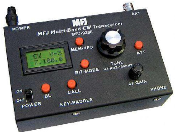
Déjà annoncé quelques semaines avant la Hamvention de Dayton 2011, ce nouveau né de la légendaire gamme des transceivers QRP chez MFJ entreprise Inc est un émetteur/récepteur CW qui peut être utilisé sur 6 bandes du 80 au 15m. Le choix de la bande est réalisé par des modules interchangeable. Il est très compact et léger (200 gr). Sa puissance de sortie est de 5 watts et il s'alimente entre 8 et 15Vdc par une source de tension extérieure.
