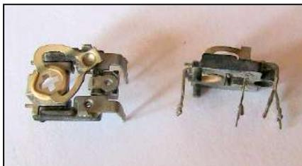
donc un commutateur à trois positions réalisé sur la base d'une résistance ajustable. On le trouvait principalement dans les TV couleur. Il commutait des circuits pour la mise au point de celles-ci.
