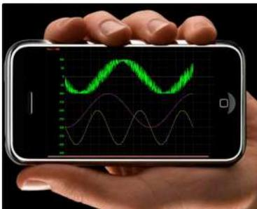
Le iMSO-104 est un module qui permet de transformer en oscilloscope numérique un iPhone, un iPod touch ou un
