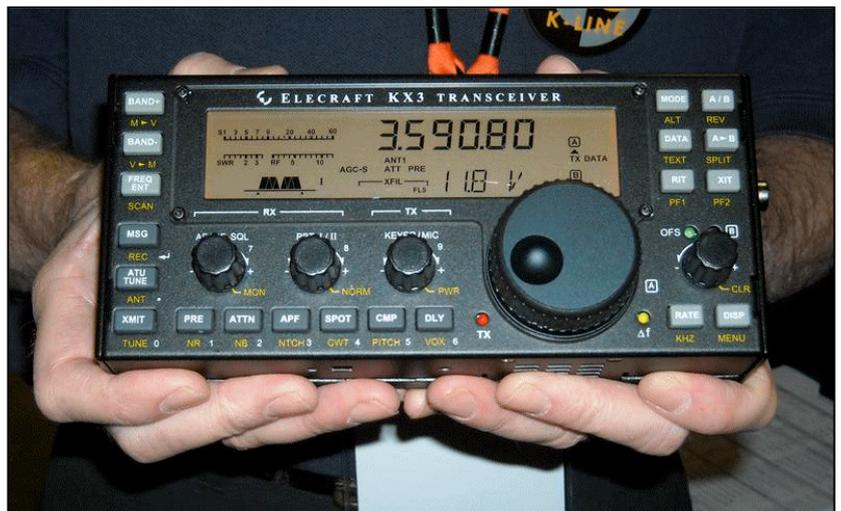
Le KX3 peut être utilisé partout grâce à ses 2 pieds arrières rabattables et sa fixation optionnelle pour l'utilisation en mobile. Ses dimensions sont si réduites qu'il met le monde à votre portée dans la main. Avec son haut parleur intégré et moyennant la connexion d'une antenne télescopique, il peut véritablement être utilisé comme un portable
