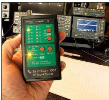
La base du générateur XG3 est le circuit intégré multiplicateur d'horloge CS2100-CP du fabricant Cirrus Logic. La fréquence programmée est obtenue grâce à une boucle de phase programmable (PLL) qui multiplie (ou divise) la fréquence d'un quartz de référence à 10MHz. Pour
