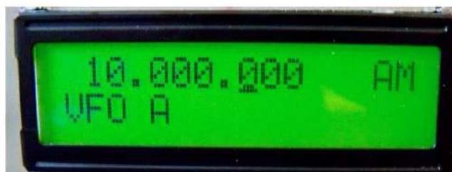
Connecter en volant un fil sur la sortie HF, Comme indiqué sur la photo 13, allumer et écouter votre récepteur sur +/- 10 MHz. en LSB ou USB. Vous allez entendre un fort sifflement,
