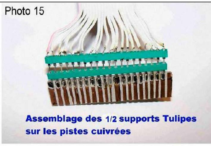
Tulipe de 20 picots, embrochables sur un autre 1/2 support Tulipe identique, commande les diverses fonctions du circuit imprimé du synthétiseur (V. F.O.) de PA0KLT. Sur ce support Tulipe qui est soudé sur une plaquette époxy cuivré isolé de la masse avec
