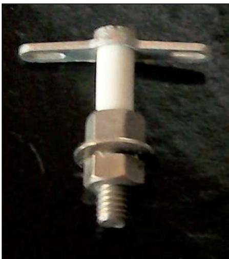
Il s'agissait d'une cosse relais sous forme d'un pilier de montage pour les composants. On visse la partie inférieure sur un châssis métallique et on soude les composants aux deux œillets en haut. Il n'a pas d'autre fonction que celle-là. La hauteur du pilier permet d'éloigner les composants de la masse. C'est surtout utile en HF.
