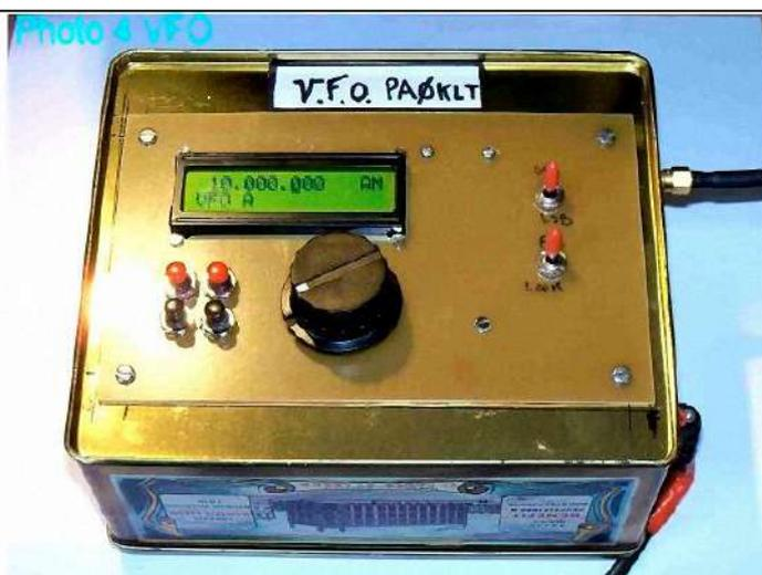
Vous reporter aux photos 9 et 10 au début de l'article. Le synthétiseur est installé sur une plaquette en époxy de 100 X 160 mm. Quatre trous sont percés dans les angles pour la fixation en façade. L'ensemble synthétiseur (V. F. O) peut être monté dans un coffret ou dans une boîte à gâteaux. Les photographies 4 et 6 donnent une idée de la réalisation.
