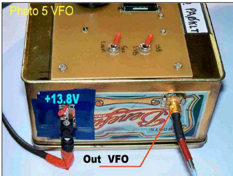
Photo 5 détail de la sortie HF par prise SMA du synthétiseur V.F.O. PAOKLT (ou autre BNC etc.), également la prise alimentation 13,8V.
