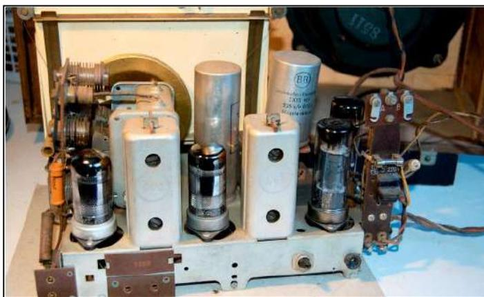
Pas d'illusion à se faire, les condensateurs électrolytiques de l'époque sont séchés. L'oscilloscope, branché à travers un transformateur d'isolement, montre plus de 60 Volts de « ripple » pour une Haute Tension de 135 Volts ; ce qui se traduit par le beau ronflement dans le haut-parleur. Je les remplace, -cela fait tout de même deux heures de boulot et avant cela, il fallait en dénicher. On n'en fabrique plus depuis 1990. Enfin cela s'arrange.
