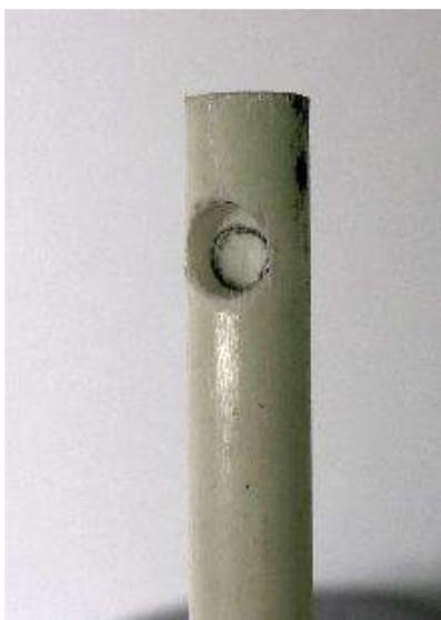
A droite : pour éviter que cela ne se produise, et que l'axe dérape sous la vis, il faut percer un petit trou de 2 ou 3mm de profondeur avec une mèche de 4mm. On bloquera la vis avec une goutte de vernis à ongle.
