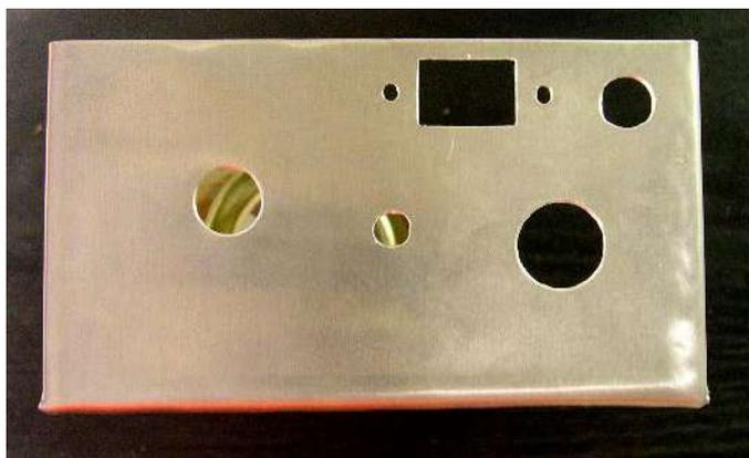
La face avant terminée. Les trous en haut étaient destinés à recevoir un galvanomètre et un potentiomètre pour un ampèremètre d'antenne. Les résultats ont été décevants au point de vue précision et le projet a été abandonné. Une nouvelle face a été créée
