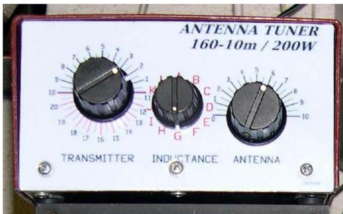
Et voilà le résultat ! Les boutons sont distribués par Velleman. La face avant est fixée par une cornière en alu. Cela permet un ajustage précis de son montage. Il faudra la fixer d'abord sur le fond en alu. Les trois trous de vis seront percés d'abord puis pointés sur la cornière (marqueur à l'alcool). Elle sera démontée et les trous seront percés avec précision.
