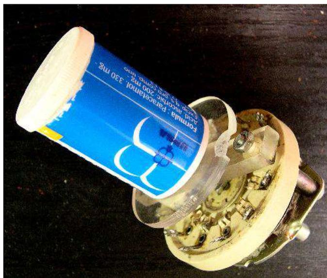
Deux vues du support de la self. Intercalez une large rondelle métallique en dessous de l'écrou dans le fond de la boîte
