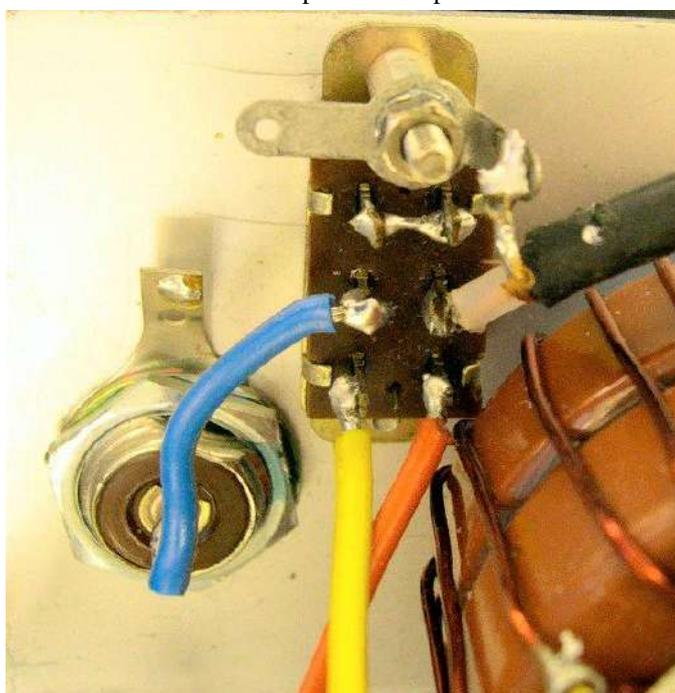
Le commutateur de mise en service du coupleur ou de by-pass. Une cosse à souder a été montée pour raccordement à la masse de la tresse du coaxial.
