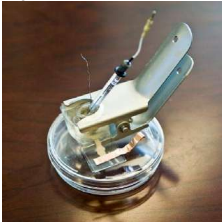
Cette version de la cellule photoélectrochimique, qui a été utilisée pour les tests de laboratoire, contient une solution de produits photoactifs (dans un cylindre de verre maintenu en place par une pince en métal) avec deux électrodes en saillie à partir du haut, une en platine (le fil dénudé) et l'autre d'argent (dans un tube de verre). Photo: Patrick Gillyoly
