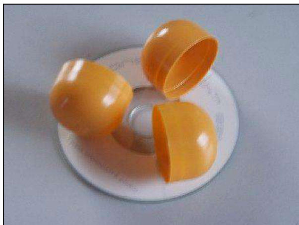
Un miniCD (Diam. 32 mm) et trois coupelles d'oeuf surprise sont l'âme de l'anémomètre
