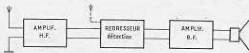
Fig. 11-1. — Composition d'un récepteur à amplification directe.
