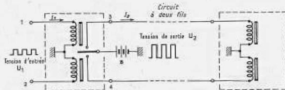
Fig. 6-1. — Représentation schématique d'un relais télégraphique.
