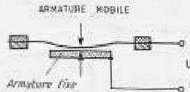
Fig. 4-6 a. — Principe du haut-parleur électrostatique.
