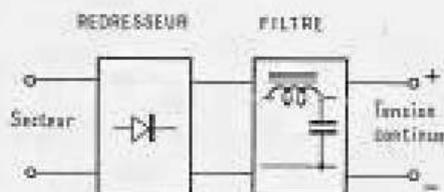
Fig. 17-8. — Diagramme pour la production de tension anodique par redresseur, et circuit de filtrage.
