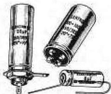
Fig. 2-8. — Condensateurs électrolytiques.
