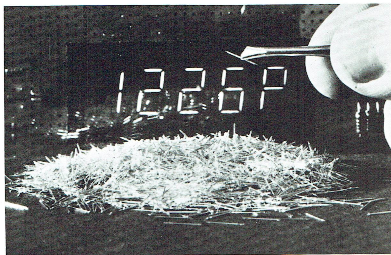
Capsules de mercure pour l'amélioration des performances de certains dispositifs de visualisation.
