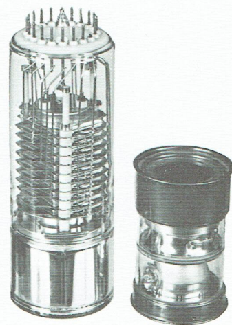
Tube photomultiplicateur réalisé en verre 732.01 Tube transformateur d'image réalisé en verre 747.01.
