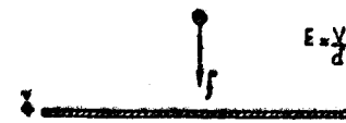
Figure 3. — Le champ électrique E qui existe entre les deux plaques fait apparaître une force f sur l'électron. Cette force a pour valeur, en dynes : 1,59.10^{-20} E volt/cm.
