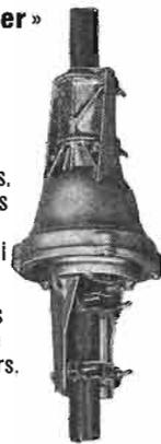
Moto-rotor étanche à l'humidité, solidité à toute épreuve, supporte une charge d'équipements (mâts et antennes) jusqu'à 70 kg, fonctionne sans peine par vents violents, fixation sur mâts Ø 22 à 50 mm, alimentation secteur 220 volts, temps de rotation complète : 55 secondes.
