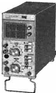
**DÉVIATION VERTICALE** : Simple trace, bande passante du DC à 1 Mhz, temps de montée 350 nano-S, atténuateur 10 positions (10 mV/div. à 5 V/division), Impéd. d'entrée directe 1 MΩ/40pF. et 10 MΩ/25 pF avec sonde 1/10.
