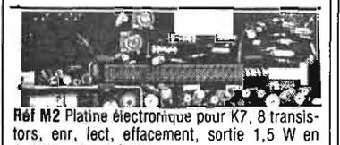
Réf M2 Platine électronique pour K7, 8 transistors, enr, lect, effacement, sortie 1,5 W en 8 ohms. Pour EC 70 et la série MK, commutation enr. lect. Dim 19 x 7 x 2,5 cm
