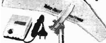
**ANTENNE ELECTRONIQUE**, sous capot étanche, larg. 59 cm, réception tous canaux VHF (bandes I et III) et UHF (bandes IV et V), utilisation possible en radio FM, ampl. incorporé, gain 20 dB (VHF et UHF) sortie 75 ohms, alimentation mixte accouplée en bas de câble coaxial : 12 V batterie (consommation négligeable) et secteur 220 V
