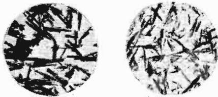
Vue microscopique de particules d'oxyde de fer, d'oxyde de chrome.
