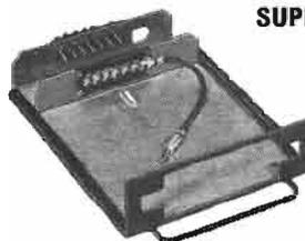
L'autoradio est monté sur un tiroir coulissant qui s'insère dans un support fixé à demeure dans ou sous le tableau de bord. Les raccordements H.P., antenne et alimentation sont reliés à un connecteur mâle sur le tiroir, qui s'enfiche dans son équivalent femelle sur le support. Une poignée sur le tiroir permet le retrait de l'autoradio, pour le soustraire à toute « convolite » et sert également d'anse de portage. L. 195. H. 65. P. 215 mm.
