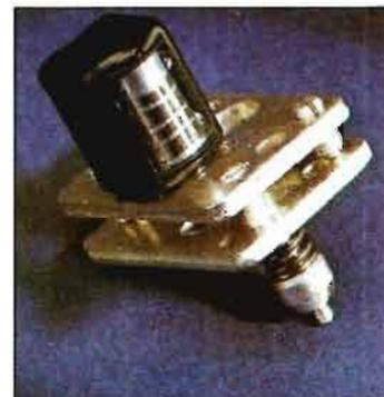
Réalisées en alliage FSX - introduit par PHILIPS - elles sont remarquablement résistantes à l'usure et permettent d'obtenir des signaux de haut niveau sans saturation. La réalisation sans laminage permet d'obtenir une surface parfaitement polie et une largeur d'entrefer constante. Cette nouvelle tête magnétique "FSX" garantit le maintien dans le temps d'une reproduction de haute qualité avec une dynamique élevée.
