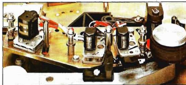
châssis mécanique est réalisé avec une plaque d'acier de 4 mm d'épaisseur.
