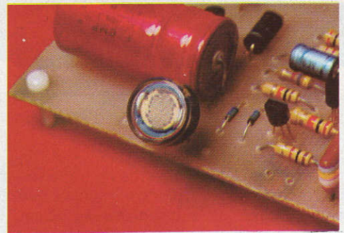
Photo 2. - Un aperçu très coloré du condensateur C_1 de filtrage et de la cellule LDR 05.
