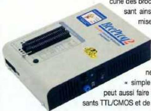
chaque des broches de son support, l'autorisant ainsi à programmer (par simple mise à jour logiciel) la plupart des composants DIL 48 broches sans aucune adjonction d'adaptateur ou de module spécifique. Enfin ce dernier ne se contente pas d'être un « simple » programmeur, puisqu'il peut aussi faire office de testeur de composants TTL/CMOS et de mémoires statiques.
