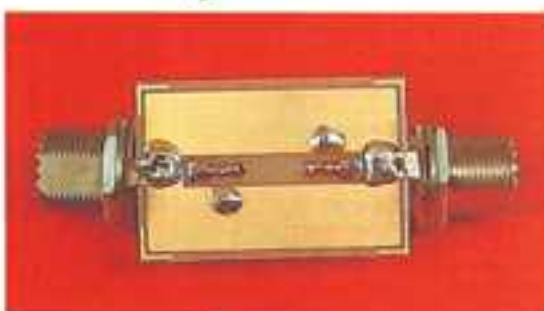
LES FICHES PL SONT PREVUES POUR VENIR ENTRE LE TX ET L'ANTENNE.
