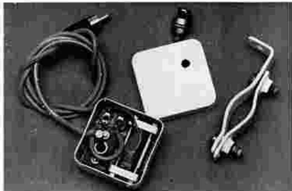
Photo 3. — On aperçoit l'étrier support destiné à la fixation des piles d'alimentation.
