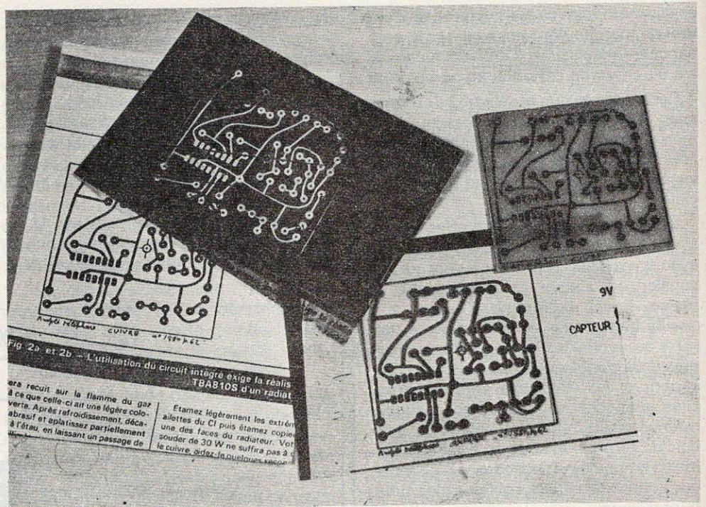
Pour préparer la solarisation, superposez dans l'ordre : le dos-presseur mousse au-dessus, la plaque sensibilisée résine au-dessus, la matrice orientée pour qu'on lise « côté cuivre » enfin à l'endroit, et la vitre mince. Saisir ce sandwich à deux mains et engagez-le dans les encoches des étriers longs disposés sur la table. Engagez ensuite les deux étriers supérieurs. La surépaisseur apportée par la plaque époxy assure la pression. S'assurer à travers la vitre que la matrice n'a pas glissé.
