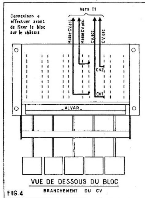
façon on réunit la broche 5 de ce support à la cosse P du transformateur MF2. La cosse G de cet organe est connectée à la broche 8 du support de EBF80. Entre la broche 5 du support de 6BA6 et la broche 7 du support de EBF80 on soude un condensateur céramique ou au mica de 50 pF. Entre cette broche 7 et la cosse a du relais B on soude une résistance de 1 M $\Omega$  1/4 W. Une résistance de même valeur est placée entre cette broche 7 et la cosse b du relais B.
