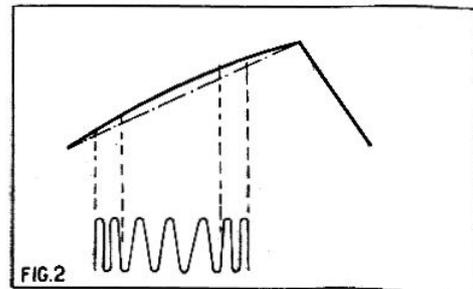
Sans lampe de charge, cette partie montante est légèrement incurvée, à cause de la forme particulière du courant de charge. En bas, l'aspect que prendrait une suite de sinusoides si l'on appliquait la dent de scie directement aux plaques de déviation, sans corriger auparavant sa linéarité.
