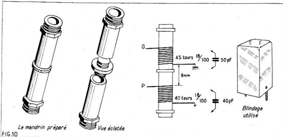
Fig. 10. — Détail de la fabrication des transformateurs MF.
