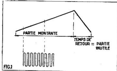
Une dent de scie se compose de deux parties qui doivent être très droites l'une et l'autre. La partie descendante représente le temps de retour; elle est en principe inutile, mais elle doit être aussi réduite que possible pour rendre possible l'observation précise de la partie active.
