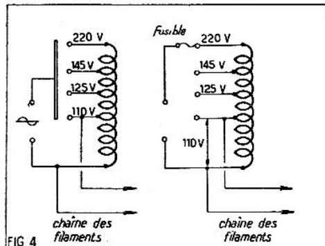
Fig. 4. — En branchant la chaîne des filaments, comme le montre la figure, on utilise le primaire du transformateur en auto-transfo. A droite, exemple pratique pour un secteur de 220 volts.
