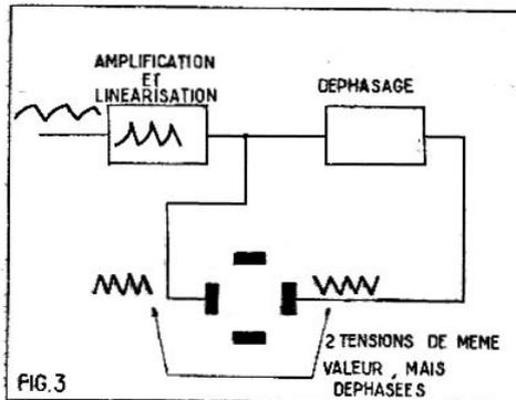
L'étage amplificateur introduit une courbure en sens opposé (la forme est exagérée pour les besoins de la démonstration). Le résultat est une linéarité parfaite aux plaques de déviation. Remarquer le déphasage entre les deux plaques.
