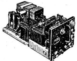
Comportant 1 clistron à cavité résonnante 6 lampes 1-EF50, 1-5Z3, 3 Stabilivolts néon, 1 valve THT, 2 condensateurs à huile blindés 20.000 V, 1 transfo gros débit, 2 grosses selfs, 2 redresseurs et un très important matériel. Le tout dans un coffret blindé et tropicalisé. Dimensions : 52 x 23 x 20. Valeur 70.000 **5.000**
