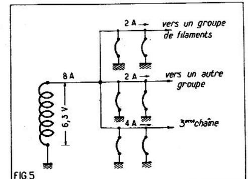
Fig. 5. — Devant les intensités qui circulent dans un téléviseur, il est préférable de diviser les diverses chaînes des filaments.
