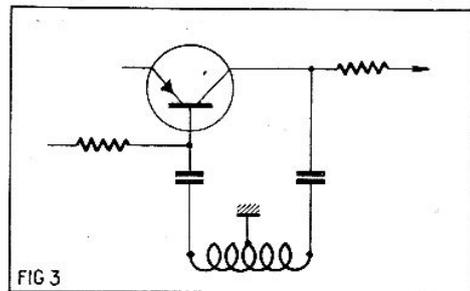
FIG.3 Utilisation du primaire d'un transformateur de modulation push-pull, comme bobinage oscillateur.
