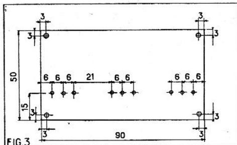
Fig. 3. — Plan de perçage de la plaquette
