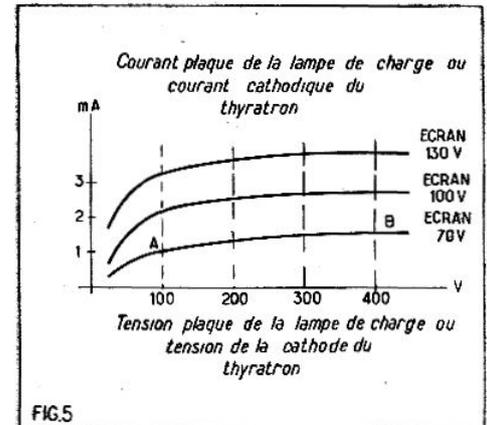
Famille de courbes d'une pentode à forte pente. On remarque que la tension anodique peut passer de 100 à 400 V, sans que, pratiquement le courant anodique ne varie. Par contre, on agit sur la valeur de ce courant en changeant la tension de la grille-écran.
