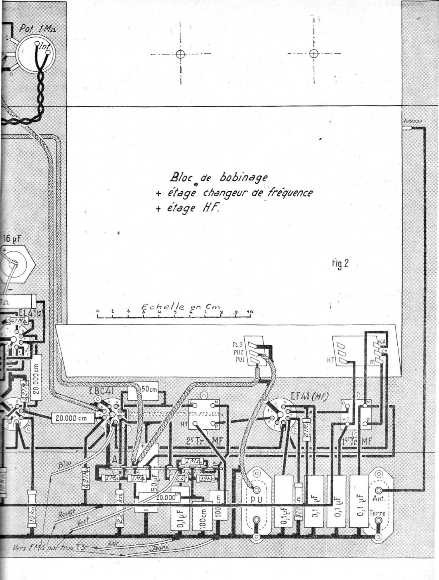
1/4 W. Sur la cosse 3 du support de la EF41 déphaseuse, on soude un condensateur de 20.000 cm dont l'autre fil est soudé sur la cosse 6 du support de la EL41 (1). Pour ceux que cette liaison pourrait étonner, signalons que la cosse 3 du support de EF41 est relative à la cathode de la lampe au même titre que la cosse 7. Entre la cosse 6 du support de EL41 (1) et la masse, on place une résistance de 0,47 M $\Omega$ .
