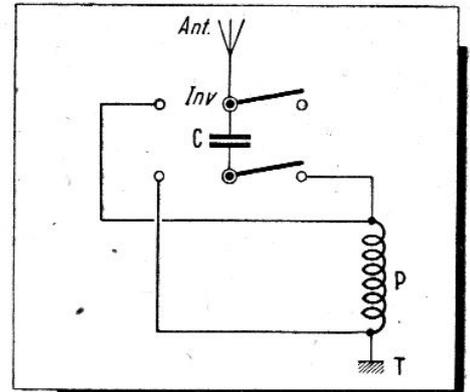
en *série* avec le primaire P. En ramenant l'inverseur sur la gauche, le même condensateur C se trouve en *dérivation* sur le primaire P. En pratique, utiliser un inverseur rotatif.
