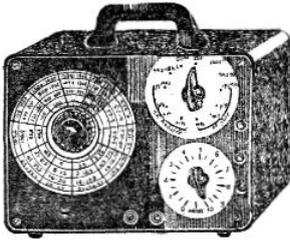
Générateur portatif à points fixes. Permet d'effectuer tous les réglages d'appareils récepteurs de radio. Gamme PO, gamme GO, Chalutier OC, OTC, MF 455 et 472 Kc. Parfaite stabilité. Précision supérieure à 1%. Équipé avec deux tubes Rimlock UCH42, UY42. Encombrement : 180 x 95 x 140. 10.300
