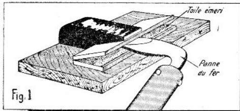
inoccupé, cas par exemple d'une légère modification *in extr mis*, du châssis, ou encore installation d'un accessoire oublié dans le châssis. Généralement, pour éviter le contretemps nécessaire au réchauffage du fer, on le laisse en circuit en attendant de pouvoir continuer le câblage. L'oxydation va alors s'étendre rapidement à la totalité de la panne, c'est-à-dire non seulement à la partie active, qui est étamée, mais à toute la surface.
