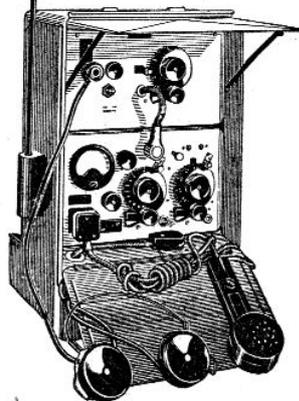
Poste émetteur-récepteur. Bande 6 à 9 Mc, 33 à 50 m. alimentation par piles. Prix de ce poste nu, à équiper, livré avec schéma et notice. 5.800
