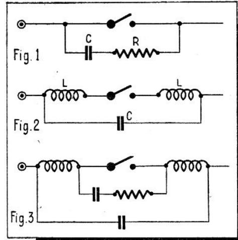
100 tours bobinés en une seule couche, d'un fil de cuivre de section appropriée à l'intensité du courant qui circule dans le circuit fermé par le contact.
