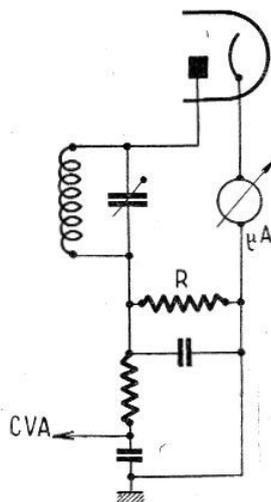
fading. Mais ce courant est très faible, il varie entre 0,5 et 15  $\mu$ A suivant l'amplitude du signal capté.
