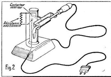
demeure inoccupé. La meilleure solution consiste à utiliser un dispositif qui réduise sa consommation à l'arrêt sans couper le courant, ce qui provoquerait le refroidissement du fer.
