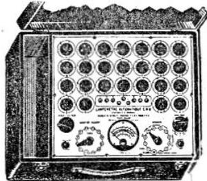
Appareil muni d'un microampèremètre à cadre mobile de haute précision. Partie lampemètre : Identique au type A 12. Partie multimètre : Contrôleur universel, à 28 sensibilités permettant les mesures suivantes : Tensions continues et alternatives de 0 à 750 volts. Intensités continues et alternatives de 0 à 3 A. Résistances de 0 à 2 M. ohm. Capacités de 0 à 10 MF. Présenté en valise gainée avec casier à outils. Prix. 33.800
