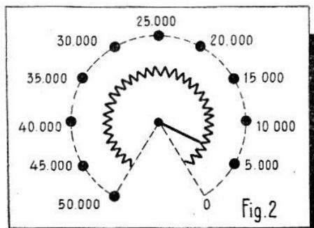
boîte à décades, peut rendre bien des services aux radiotechniciens lorsqu'ils recherchent dans un montage la valeur de résistance fournissant les meilleurs résultats; il peut aussi être utilisé dans les ponts de mesure.
