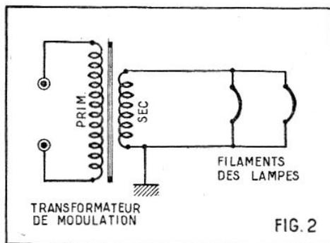
Dans ce cas, le plus simple est, évidemment, de faire un essai en branchant le primaire sur le secteur et en mesurant la tension au secondaire à l'aide d'un voltmètre alternatif ou d'un contrôleur universel en position adéquate. On doit avoir une tension légèrement supérieure à 6,3 V. Si l'on possède plusieurs transformateurs de modulation, on les essaiera successivement et l'on choisira celui qui fournira la tension la plus proche de cette valeur.
