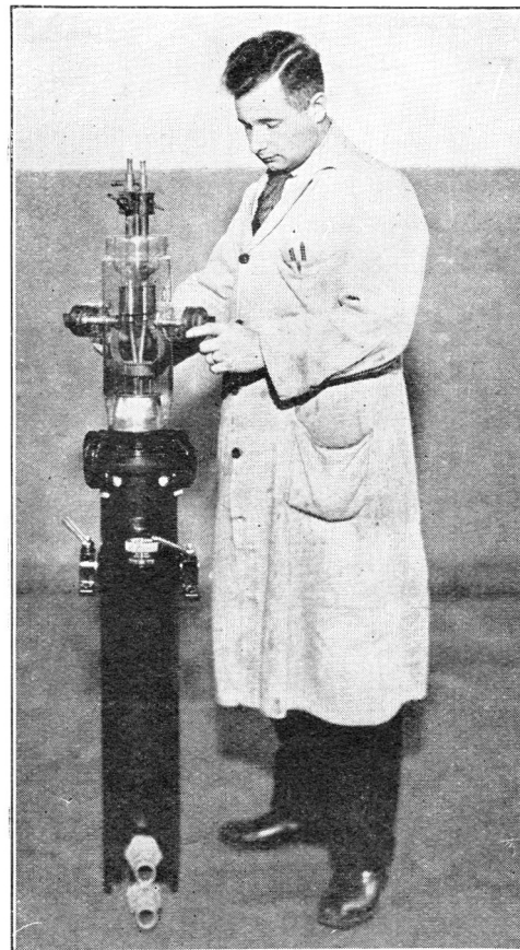
FIG. 6. — CETTE TRIODE DE 250 kW A CIRCULATION D'EAU MESURE ENVIRON 1 M 50 DE HAUT
